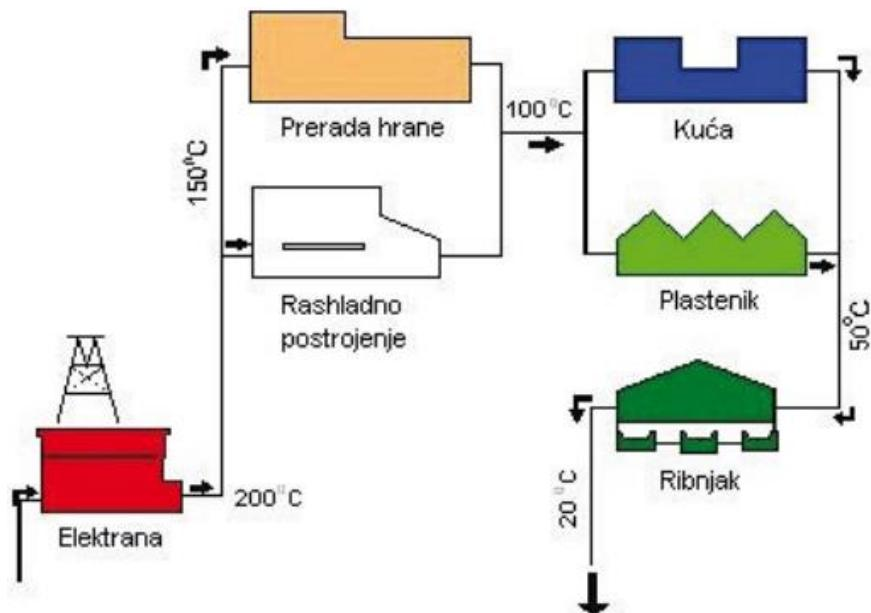
Slika 15. Upotreba geotermalne energije kaskadnom primjenom [17]
