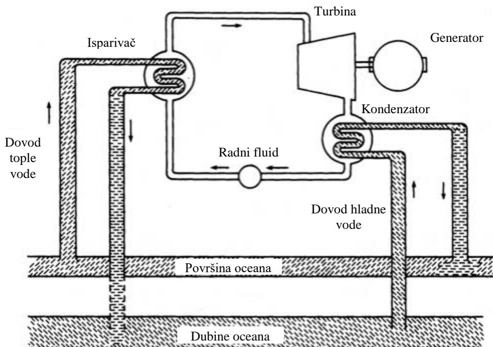
Slika 14. Shematski prikaz OTEC sustava zatvorenog ciklusa [22]
