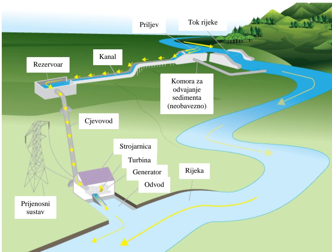
Slika 7. Protočna hidroelektrana [19]
