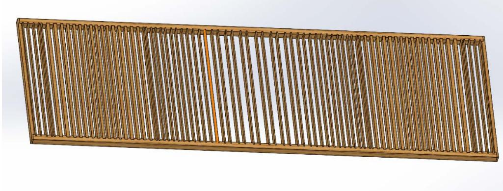
**Slika 49.** Izgled osnovice zračnice s tonskim kancelama.
