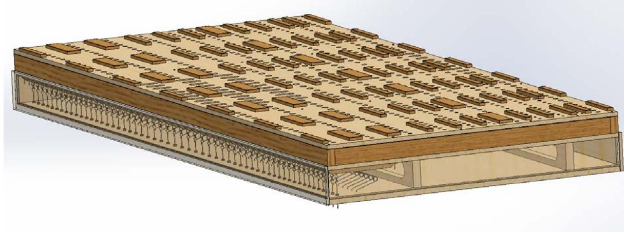
**Slika 60. Prikaz sklopa zračnice II. manuala**
