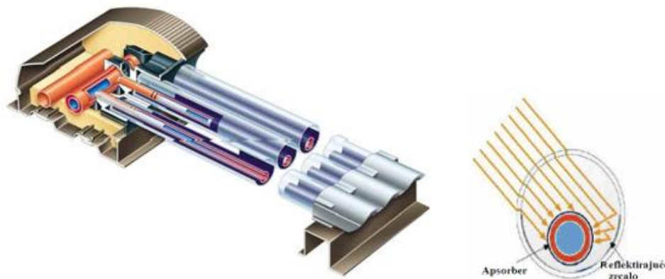
Slika 15. Osnovni dijelovi vakuumnog kolektora [4]
