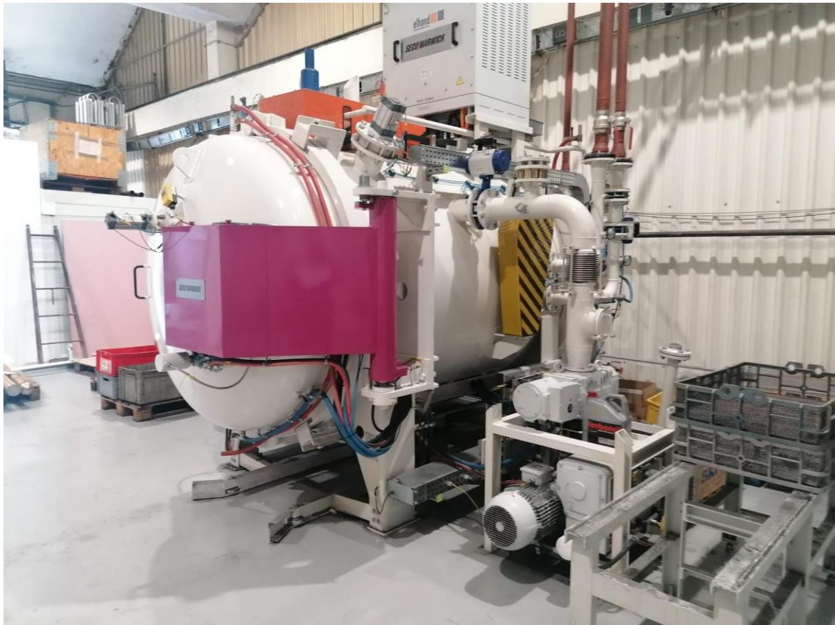
Slika 31. Vakuumska peć sa vakuumskim sustavom u Centru toplinske obrade d.o.o.
