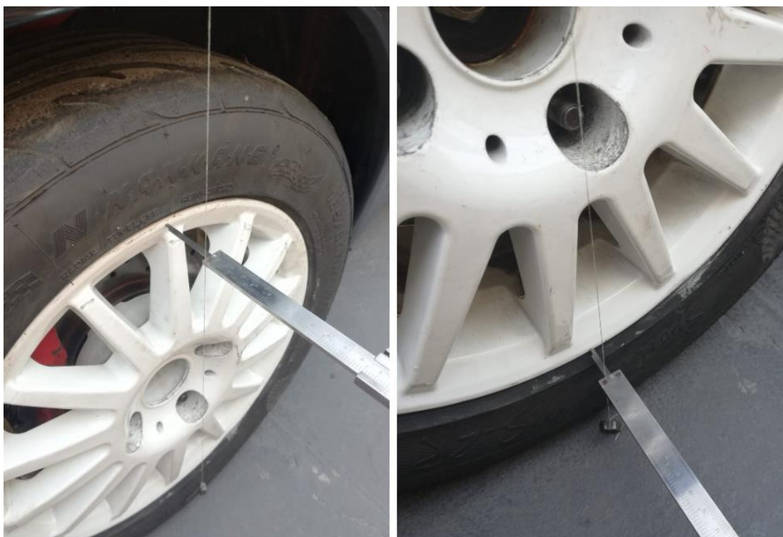
Slika 4.1. Prikaz određivanja bočnog nagiba kotača računskom metodom
