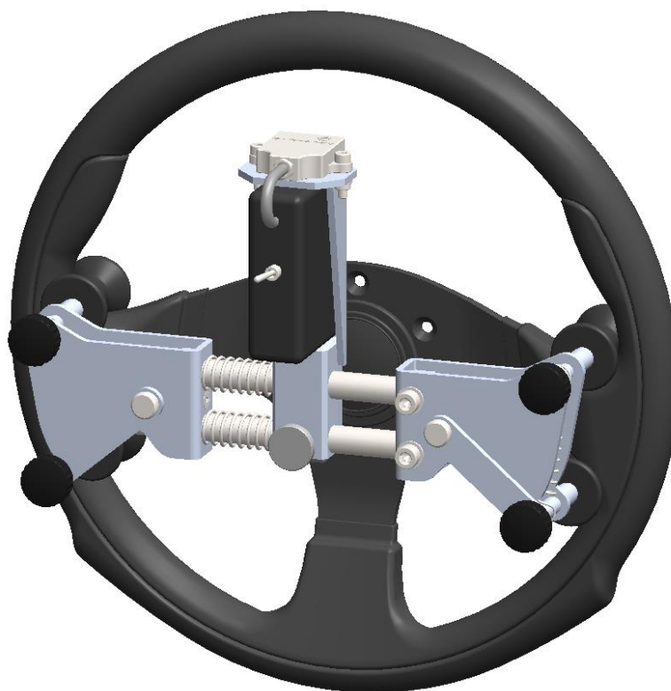
Slika 5.26. Uređaj za mjerenje zakreta upravljača montiran na upravljač
