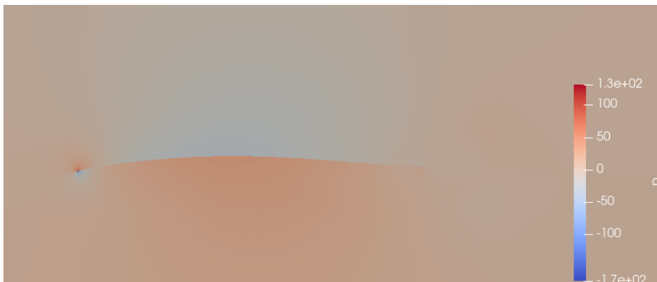
Slika 5.20: Polje tlaka oko noseće linije
