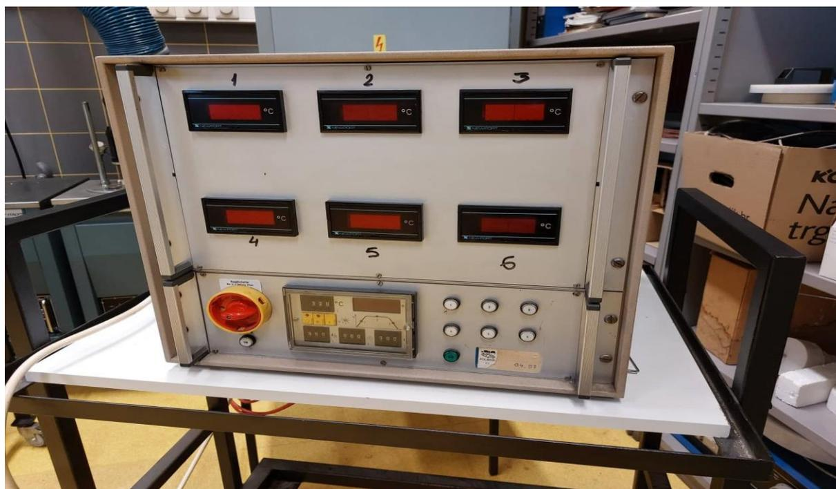
**Slika 19. Termometrijski most umjeranih termometara nepoznatog proizvođača**
