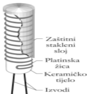
Slika 6. Prikaz izvedbe osjetnika temperature s platinskom zavojnicom
