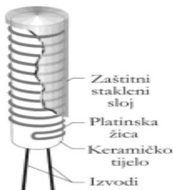
Slika 6. Prikaz izvedbe osjetnika temperature s platinskom zavojnicom
