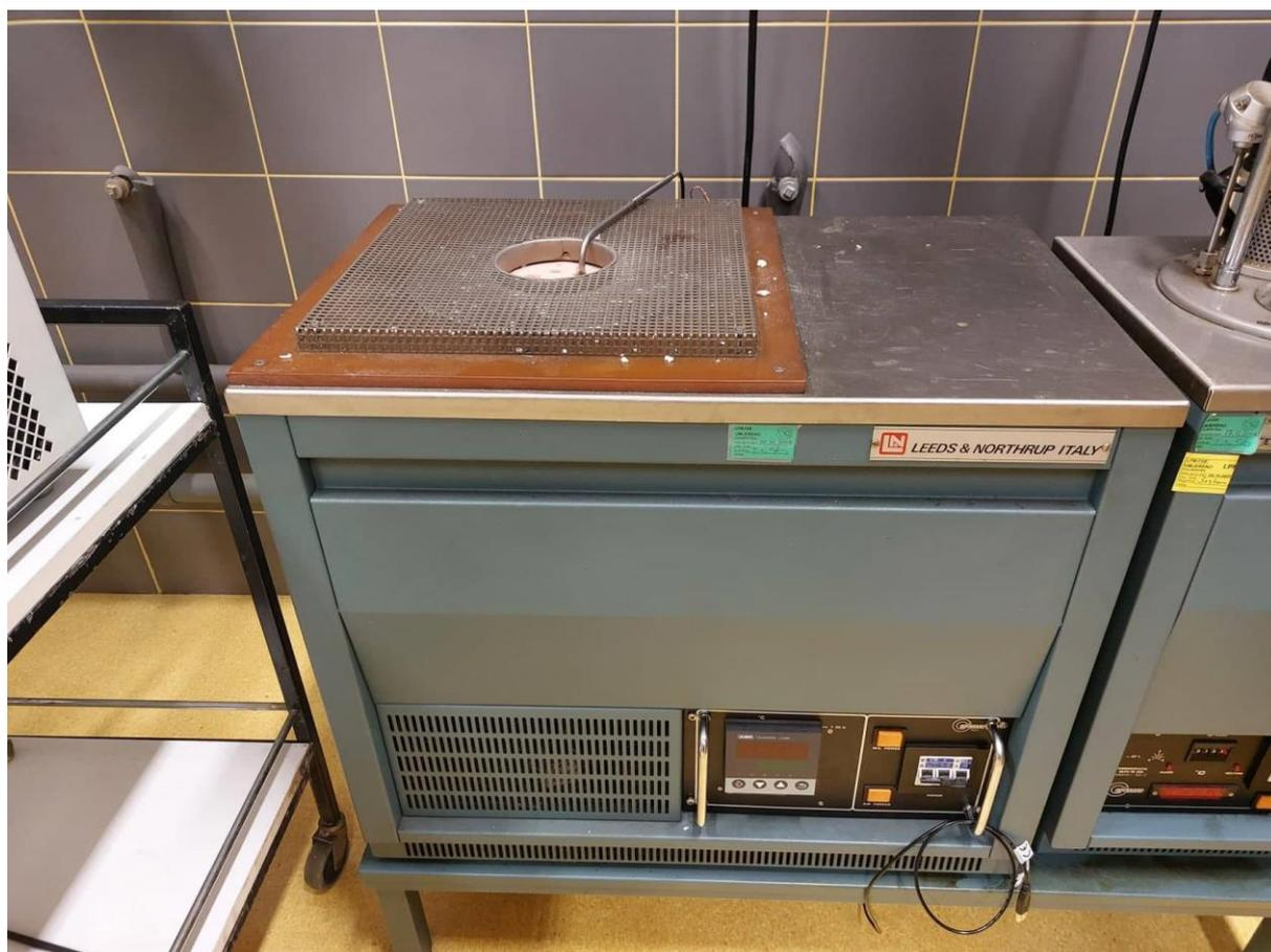
**Slika 17. Termometrijska peć proizvođača Leeds&Northrup**
