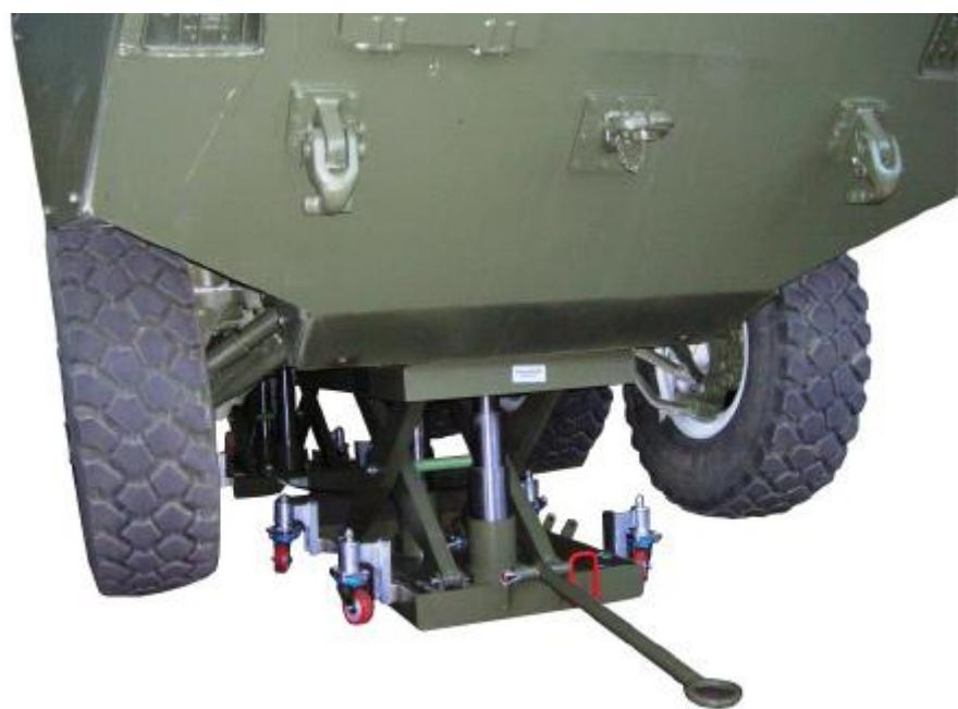
**Slika 20. Hidraulička platforma tvrtke Langa [14]**
