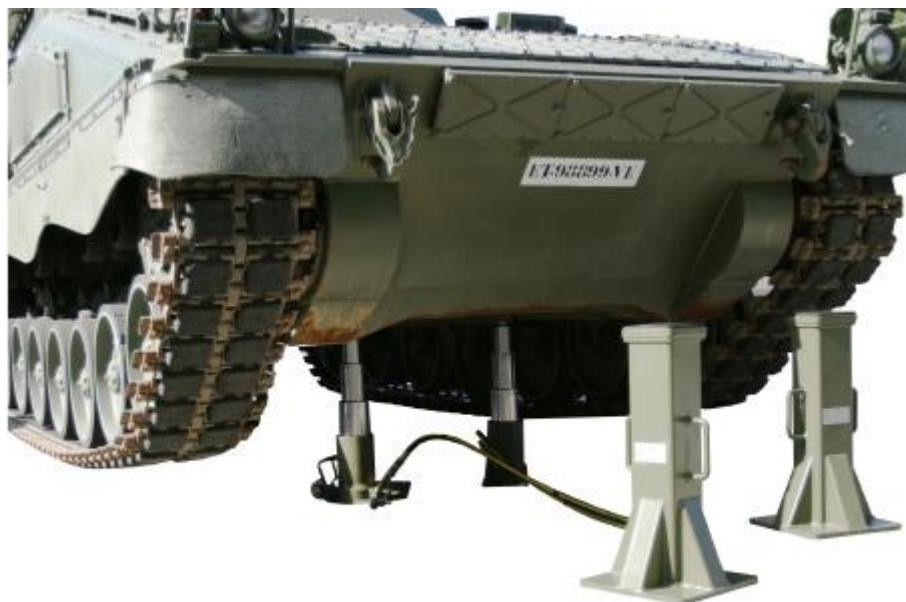
**Slika 21. Hidraulički cilindri tvrtke Langa [14]**
