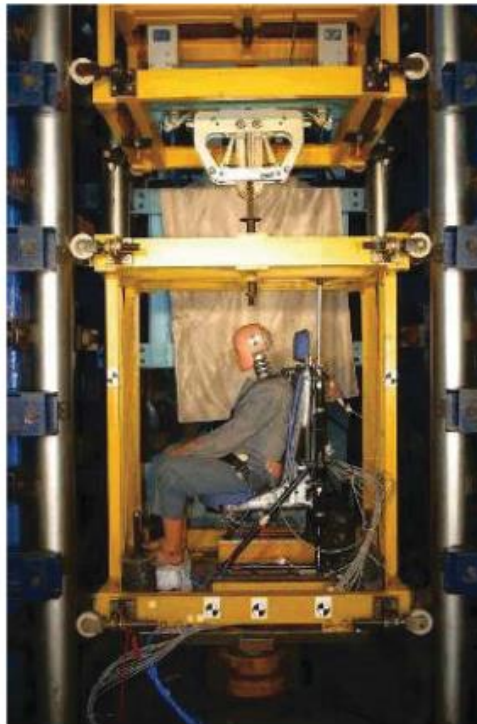
Slika 6. Montaža ispitnog objekta [12]
