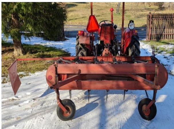
Slika 17. Okretač s beskrajnomo trakom s elastičnim zupcima (prstima)
