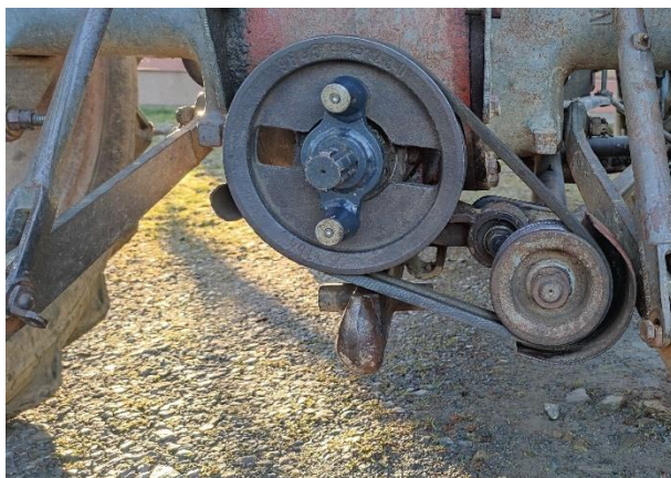
Slika 7. Prijenos snage do bočne kose remenskim prijenosom od pogonske remenice na priključnom vratilu
