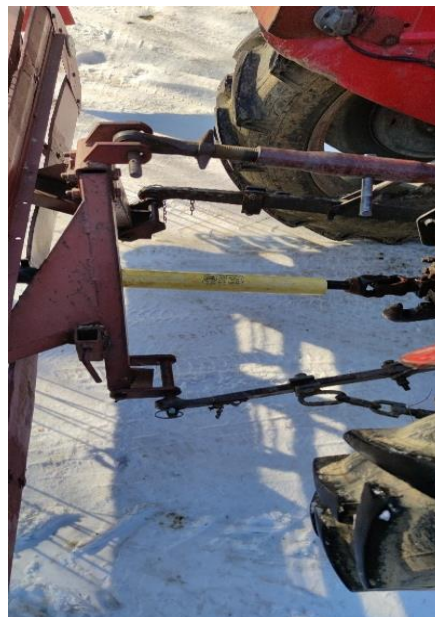
Slika 18. Povezivanje traktora i okretača trozglobnom hidrauličnom poteznicom i kardanskim vratilom
