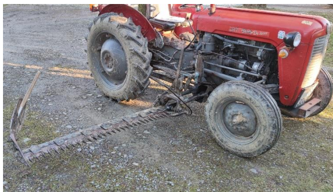
Slika 6. Oscilirajuća bočna kosa montirana na traktor IMT 539
