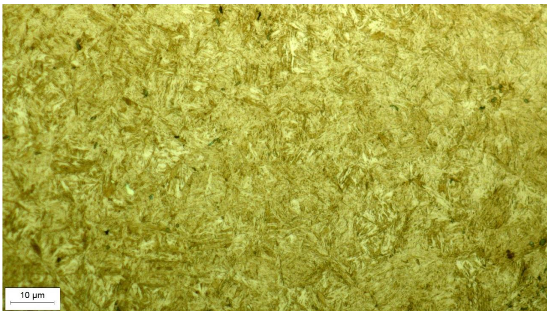
Slika 53. Mikrostruktura na rubu zuba-500x povećanje
