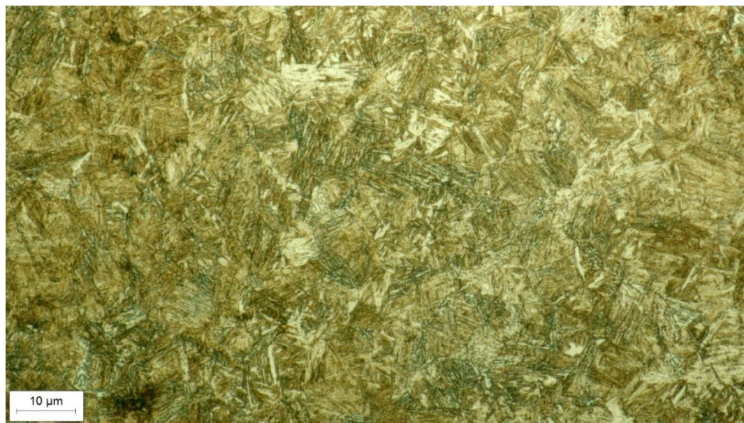
Slika 52. Mikrostruktura u jezgri stožnika-500x povećanje
