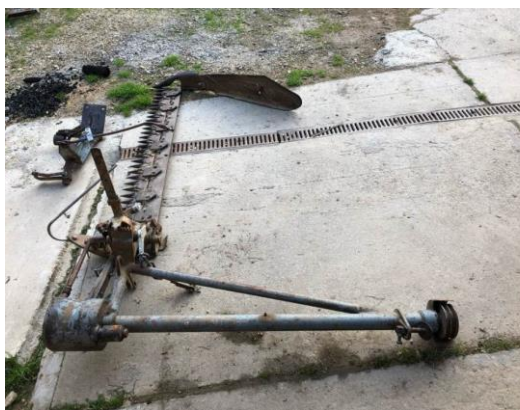
Slika 5. Oscilirajuća bočna kosa za traktor IMT 539 [9]
