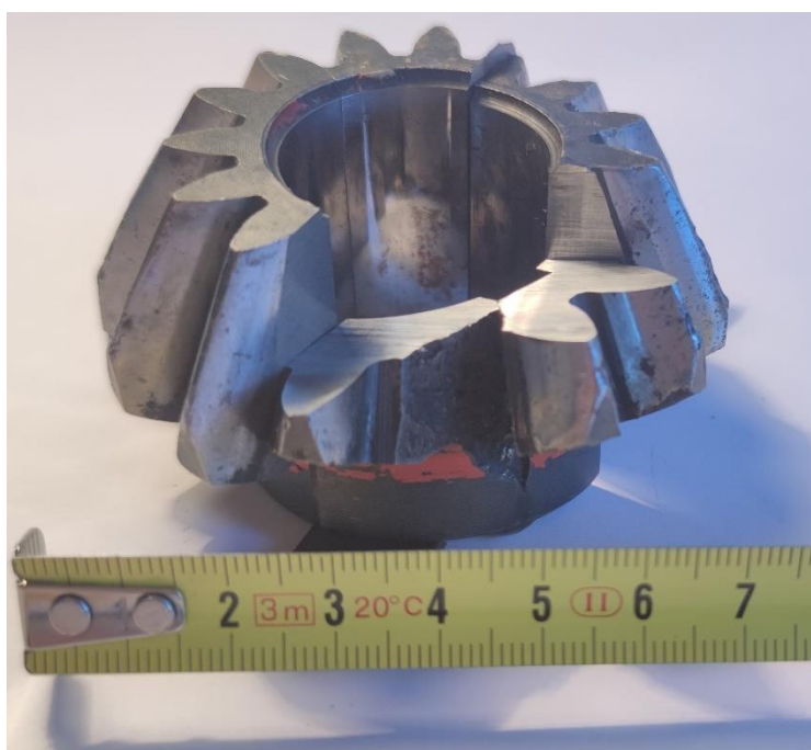
Slika 50. Preostali dijelovi stožnika na originalnim pozicijama
