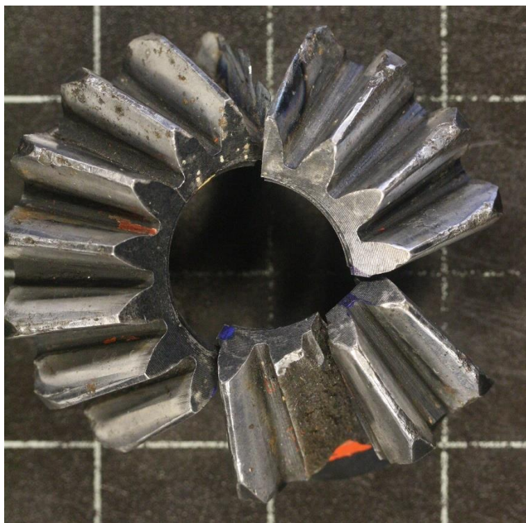
Slika 46. Izrezani dijelovi oštećenog stožnika
