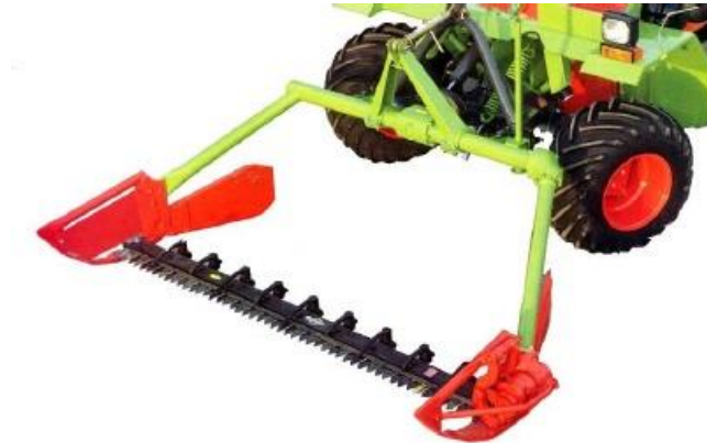
Slika 9. Oscilirajuća kosa s dva noža [7]
