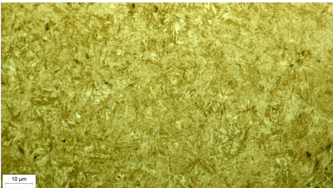
Slika 53. Mikrostruktura na rubu zuba-500x povećanje
