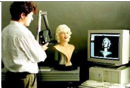
Slika 25. Prvi uređaj za 3D skeniranje – ModelMaker [15]
