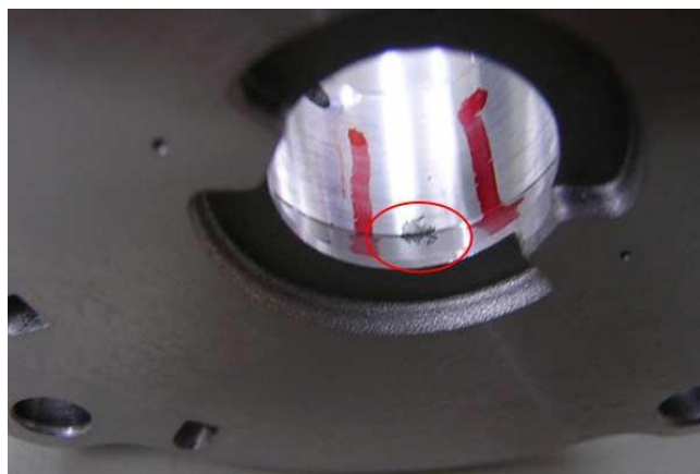
Slika 20. Uključci u materijalu odljevka [13]
