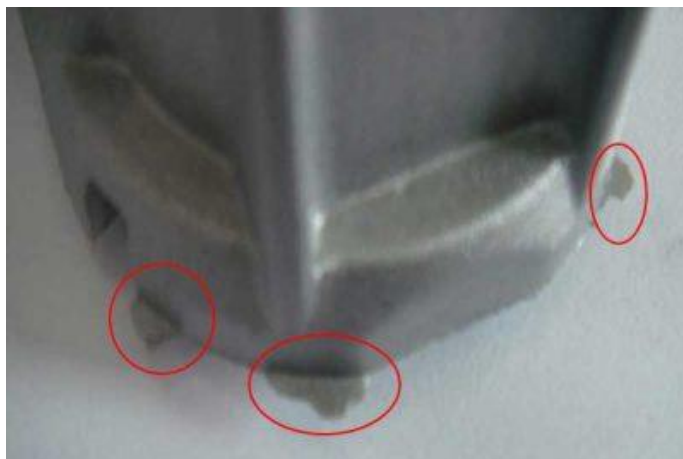
Slika 17. Rubni srhovi kod odljevka [13]
