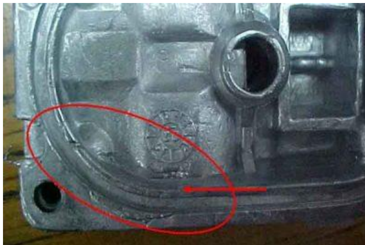
Slika 16. Nedostatak materijala u odljevku, nepotpun dio [13]
