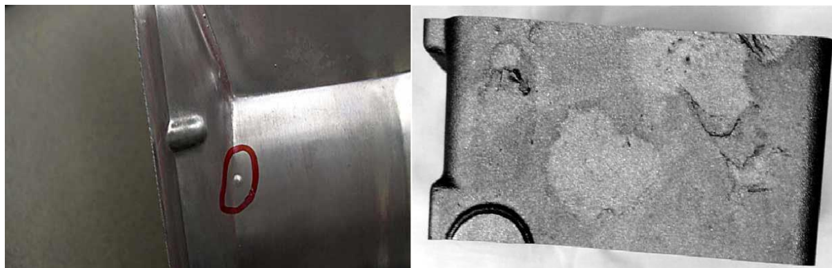
Slika 19. Ispupčenja u odljevcima [13][14]
