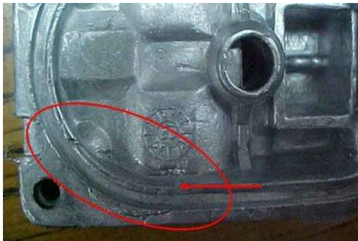
Slika 16. Nedostatak materijala u odljevku, nepotpun dio [13]
