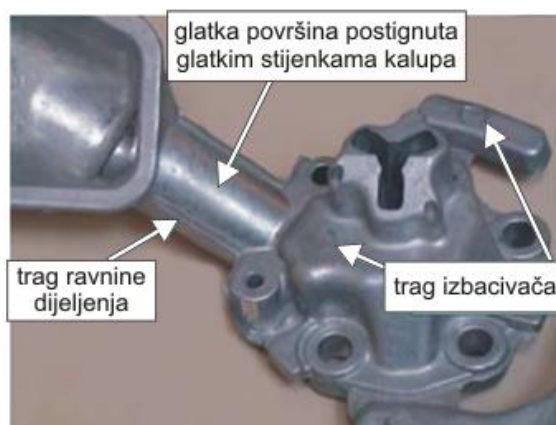
Slika 8. Geometrija odljevaka [7]
