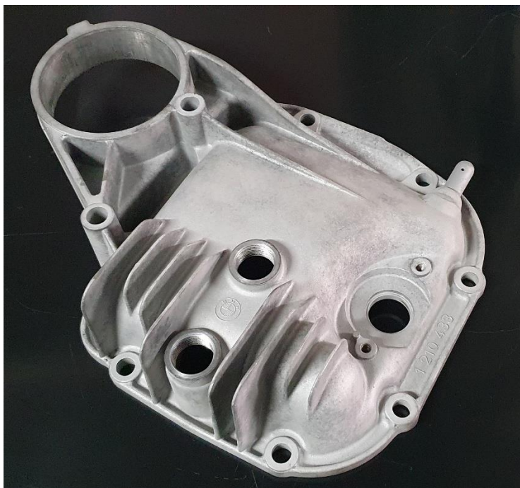
Slika 29. Pjeskareni poklopac korišten za 3D skeniranje
