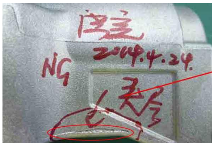
Slika 18. Međuslojevi u odljevku [13]
