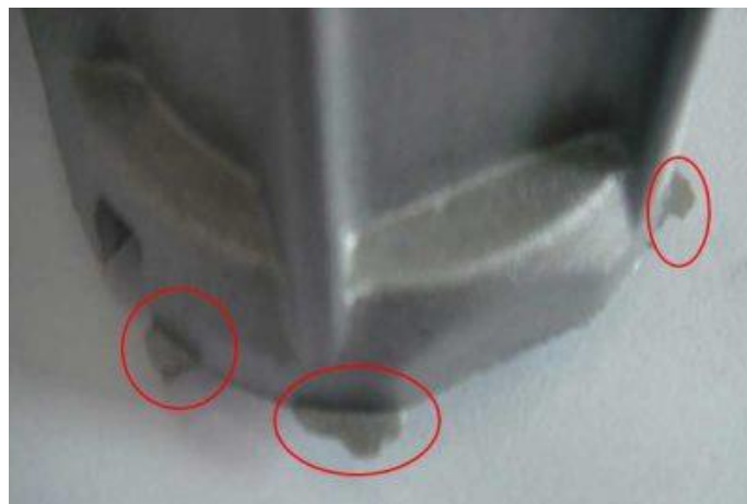
Slika 17. Rubni srhovi kod odljevka [13]
