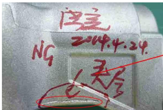
Slika 18. Međuslojevi u odljevku [13]
