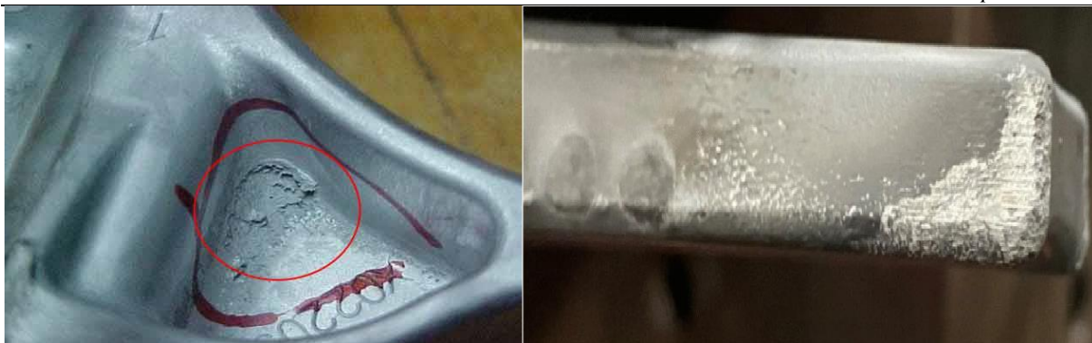
Slika 21. Naljepljivanje (lijevo) i zagrebanost površine (desno) izrađenog odljevka [13][14]
