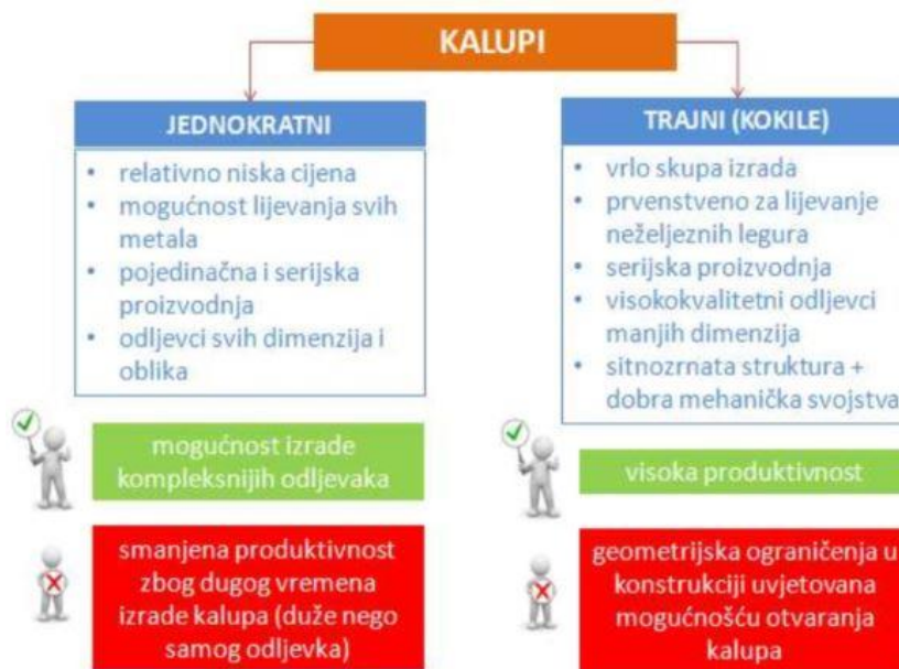
Slika 4. Osnovne značajke jednokratnih i trajnih kalupa [4]
