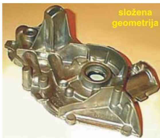
Slika 7. Odljevak složene geometrije [7]
