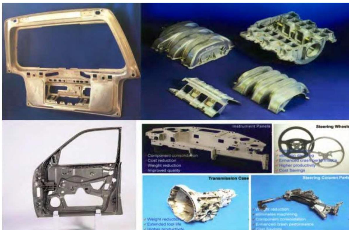
Slika 5. Tlačni lijev, odljevci od magnezijskih legura [2]
