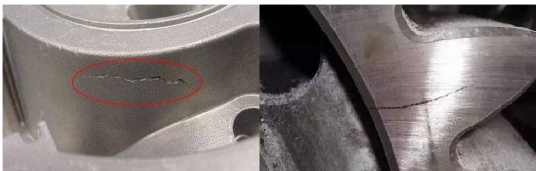
Slika 12. Pukotine u odljevcima [13][14]
