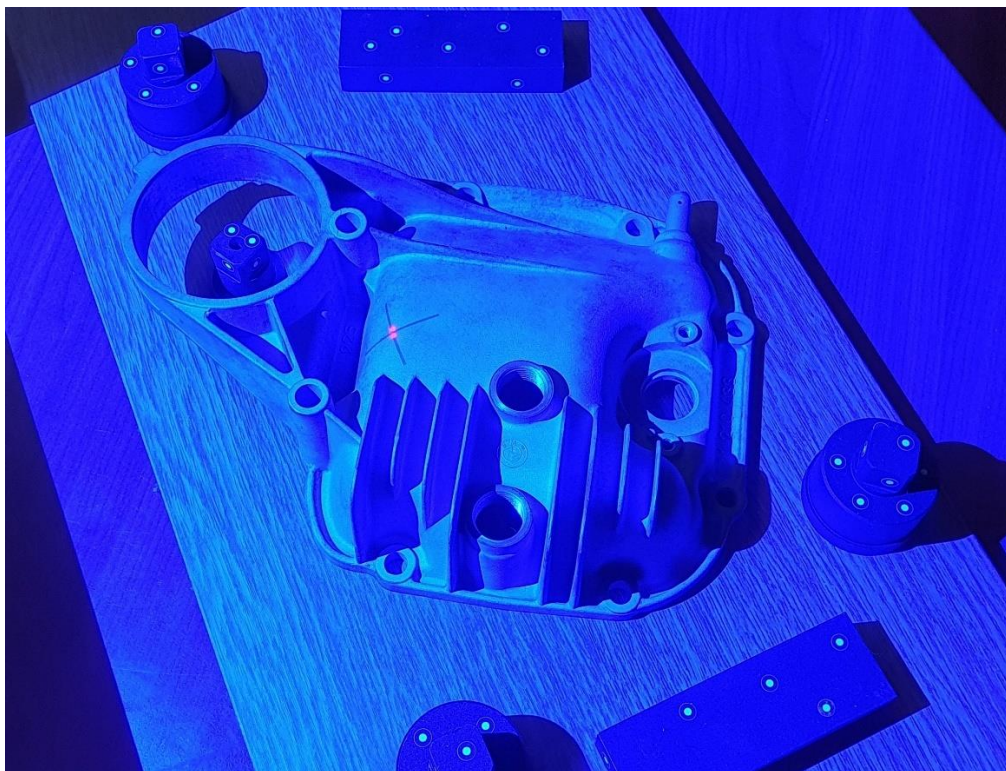
Slika 30. Postavljanje referentnih točaka oko predmeta
