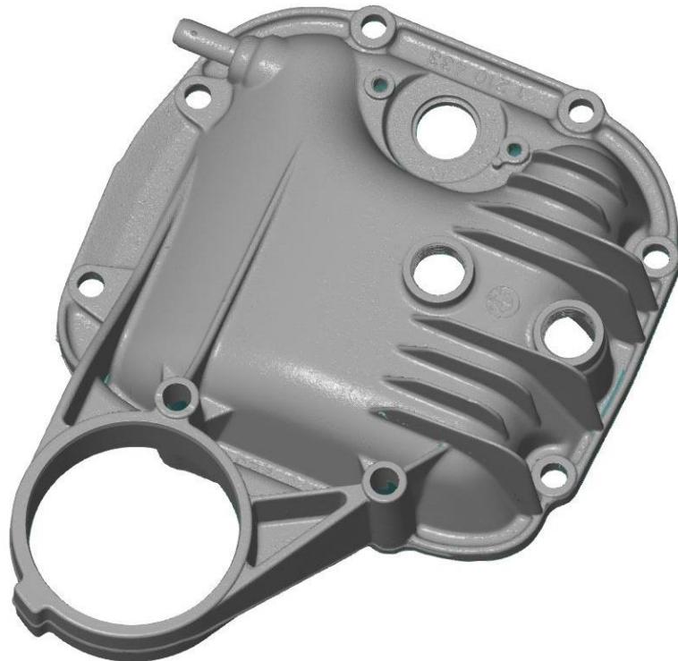
Slika 37. Spojeni model dobiven 3D skeniranjem – prednja strana
