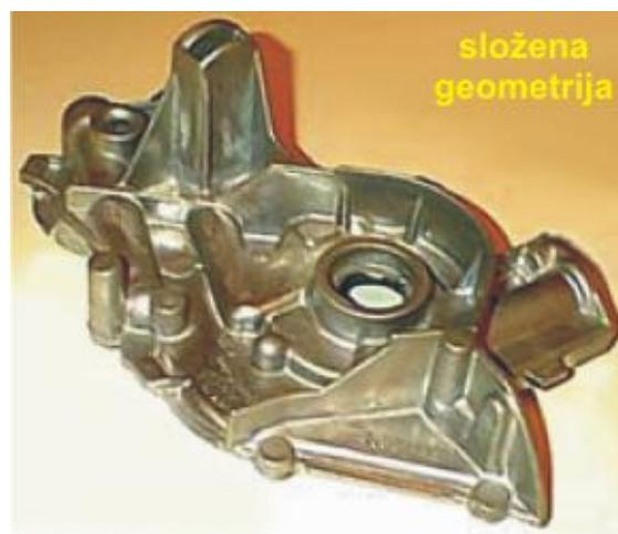
Slika 7. Odljevak složene geometrije [7]
