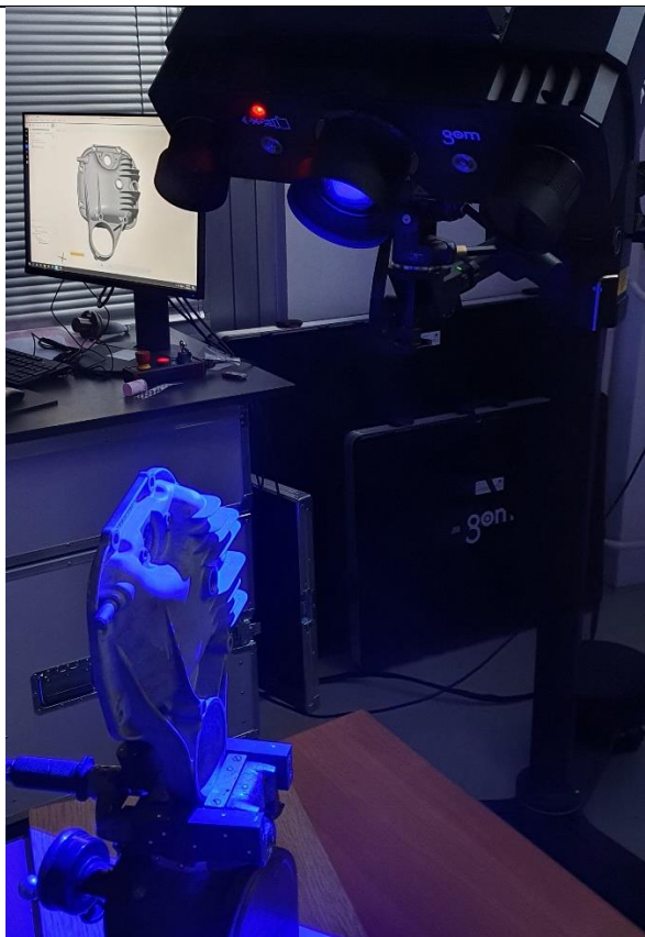
Slika 31. Prvo stezanje predmeta za skeniranje
