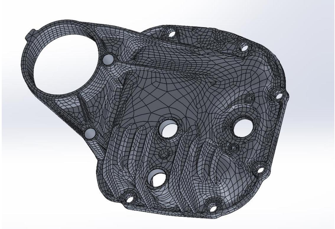
**Slika 46.** CAD model poklopca u Solidworksu
