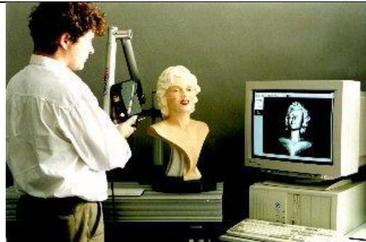
Slika 25. Prvi uređaj za 3D skeniranje – ModelMaker [15]
