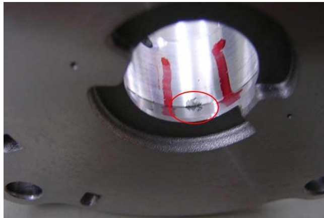
Slika 20. Uključci u materijalu odljevka [13]
