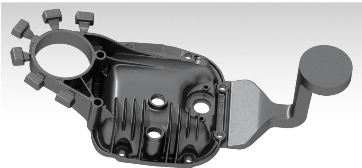
Slika 48. Renderirani CAD model sa sustavom za ulijevanje
