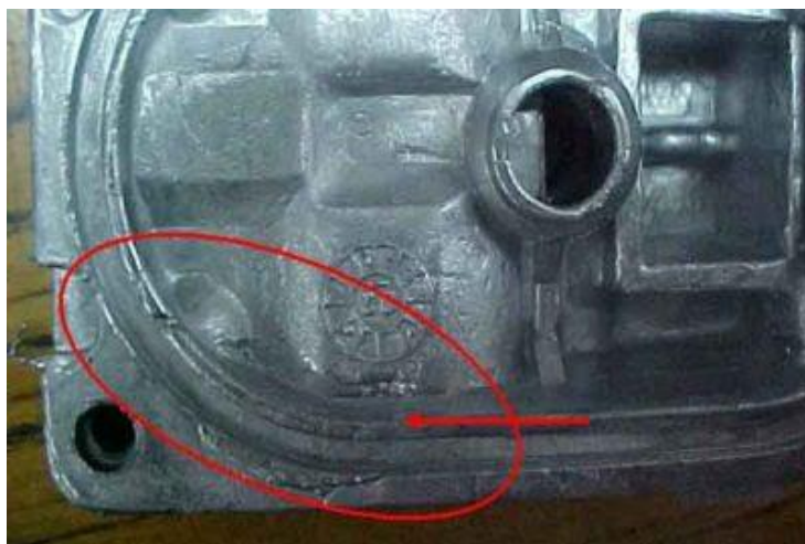
Slika 16. Nedostatak materijala u odljevku, nepotpun dio [13]
