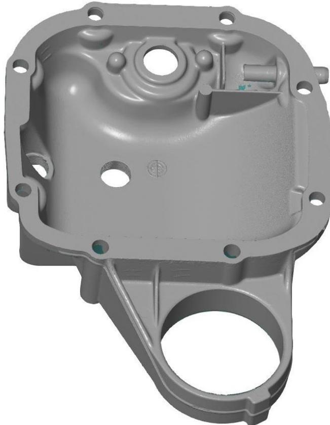
Slika 38. Spojeni model dobiven 3D skeniranjem – stražnja strana
