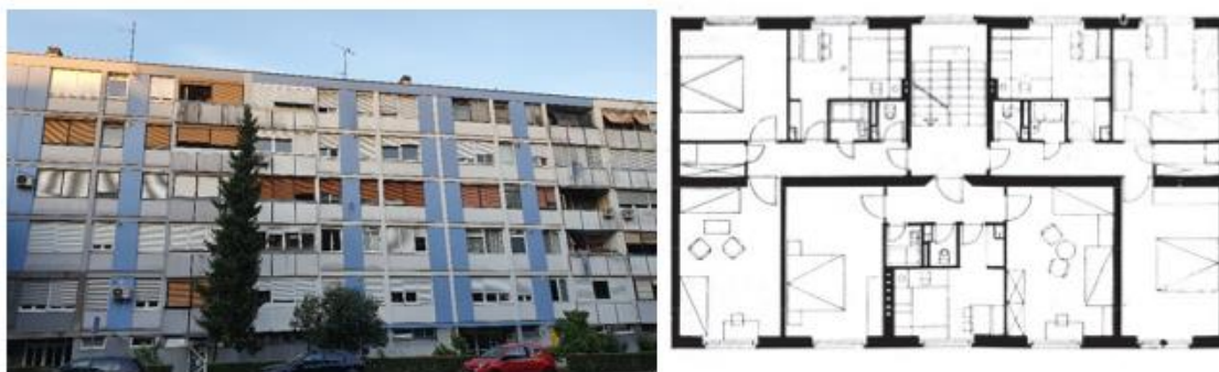
Slika 5. Stambena zgrada tip Bartolić i pripadajući tlocrt
