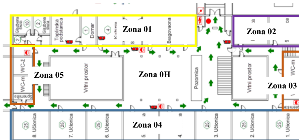
Slika 37. Prikaz toplinskog zoniranja prizemlja OŠ Trnsko
