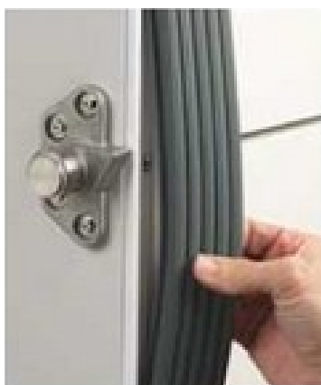
Slika 15 Brtva na vratima ULT hladnjaka [14]
