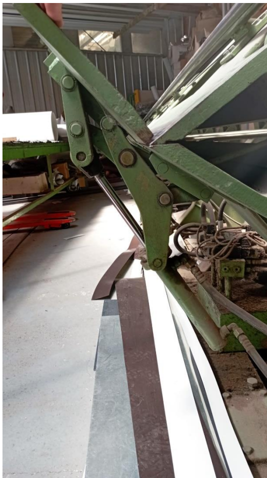
Slika 13. Zglobno-polužni mehanizam hidrauličke savijačice
