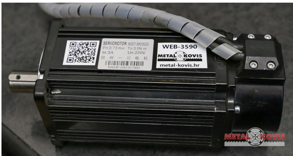
Slika 19. Servo motor za pomicanje lima [7]
