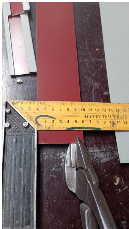
Slika 9. Označavanje pocinčanog lima
