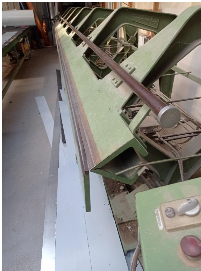
Slika 12. Savijačica lima hidraulička 8.50 m
