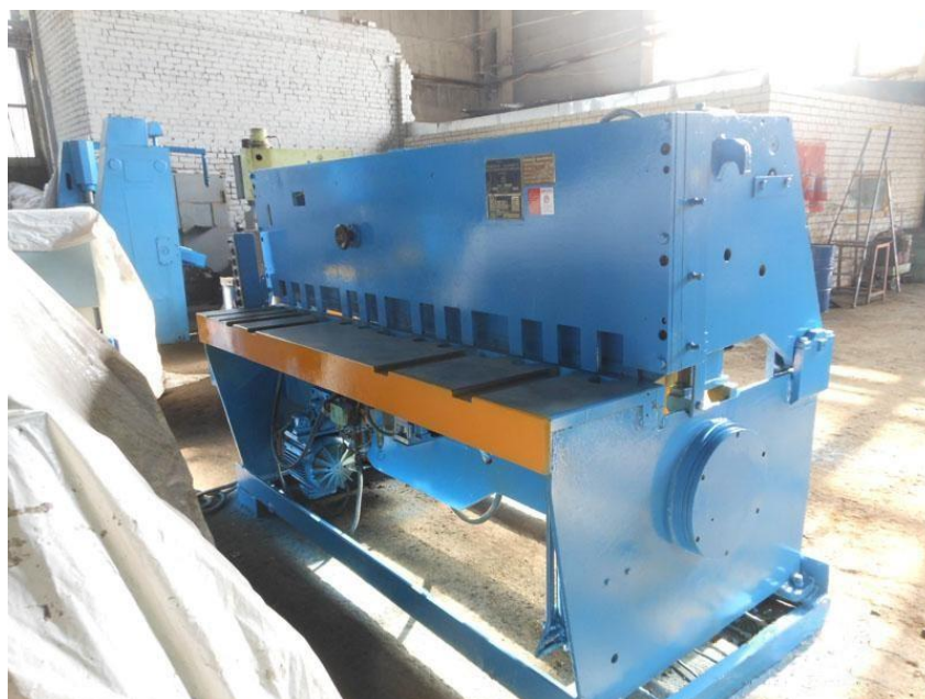
Slika 7. Mehaničke škare za rezanje lima do debljine 2mm.
