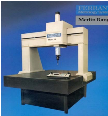
slika 1. trokoordinatni mjerni uređaj
