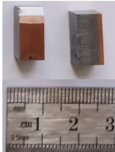
Slika 63. Uzorak ležajne bronce
