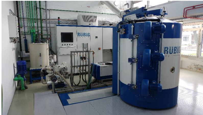
Slika 68. Uređaj PC 70/90 tvrtke Rübige
