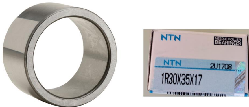
Slika 61. Nemodificirani EN DIN 100Cr6 prsten
