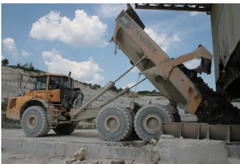
Slika 32. Kamion izbacuje sirovinu u drobilicu [41]
