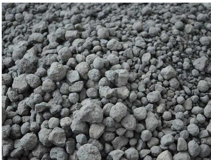
Slika 26. Poluproizvod cementne industrije – klinker [54]
