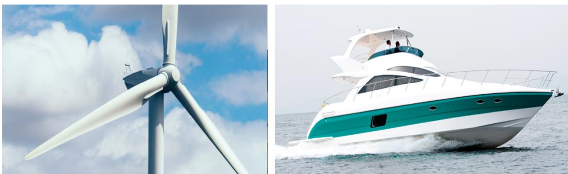
Slika 4. Najprepoznatljiviji proizvodi od staklenim vlaknima ojačanih kompozita, lopatice vjetroturbine (lijevo) [12], brodica (desno) [13]
