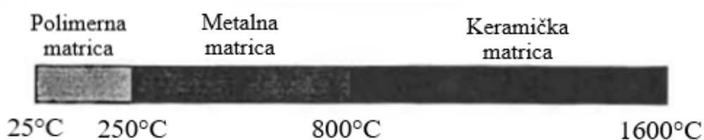
Slika 6. Usporedba temperatura primjene glavnih tipova materijala matrice [16]
