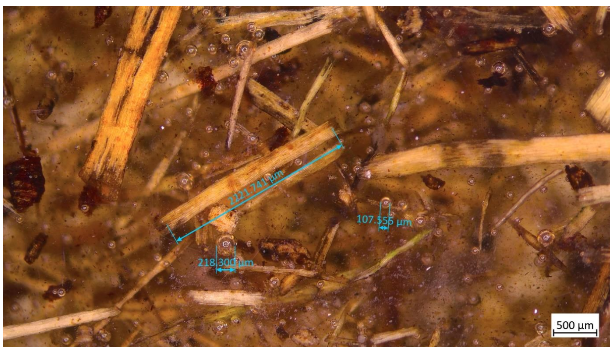
Slika 45. Mikrostruktura ispitka 4 – 10 % neobrađivanih vlakana
