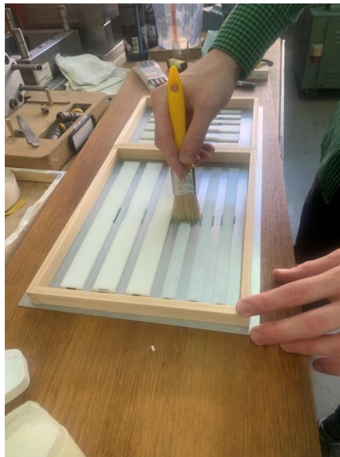
Slika 30. Premazivanje kalupa vazelinom
