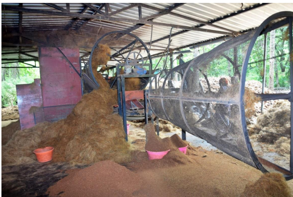
Slika 8. Stroj za odvajanje vlakna od ljuske [13]
