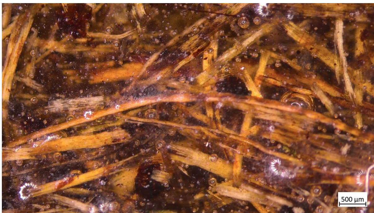
Slika 44. Mikrostruktura ispitka 1 – 20 % neobrađivanih vlakana
