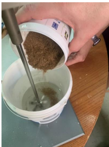
Slika 37. Postupak dodavanja vlakana u smolu
