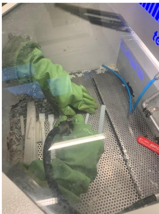
Slika 28. Naknadno čišćenje pramodela vodenim mlazom
