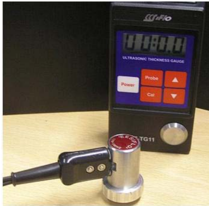
Slika 5. Ultrazvučni uređaj sa numeričkim prikazom mjerene vrijednosti
