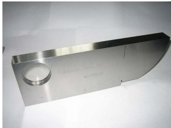
Slika 9. Referentni etalon V1
