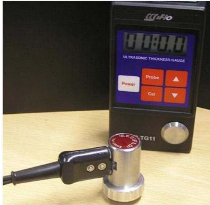
Slika 5. Ultrazvučni uređaj sa numeričkim prikazom mjerene vrijednosti
