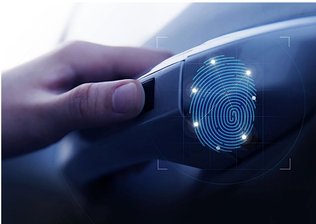
Slika 2.1. Prikaz otključavanja automobila kontaktnim senzorom otiska prsta [7]
