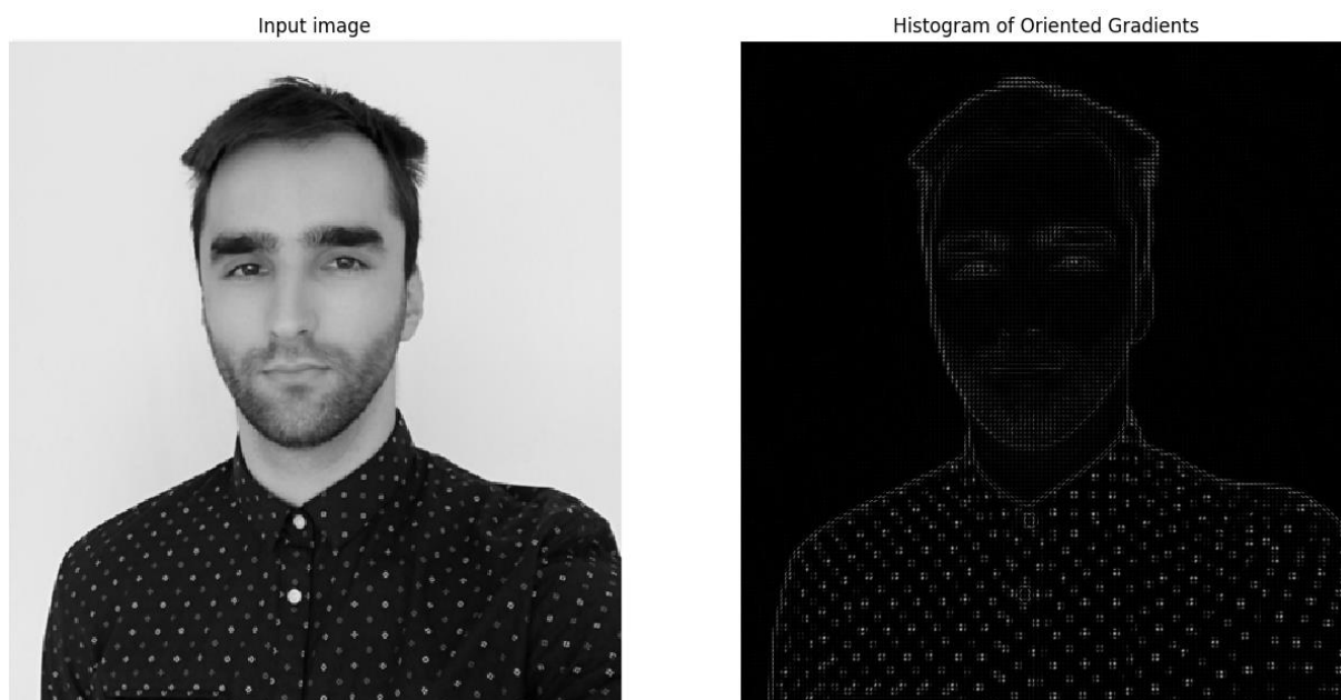
Slika 3.4. Prikaz originalne slike i rezultata dobivenog provedbom HOG metode
