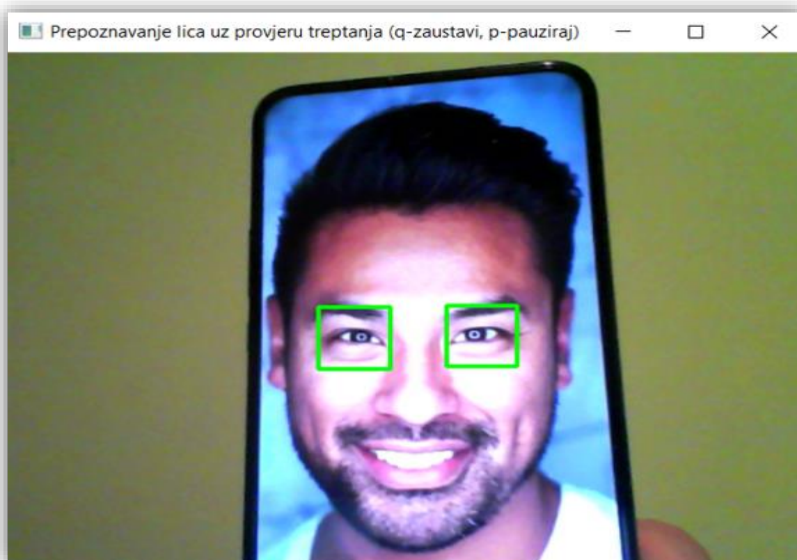
Slika 4.5. Prikaz rezultata dobivenog za pokušaj lažiranja pohađanja korištenjem fotografije ovlaštenog korisnika na mobitelu
