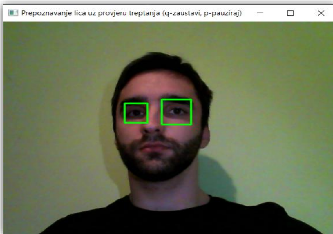
Slika 4.1. Prikaz rezultata detekcije očiju u realnom vremenu
