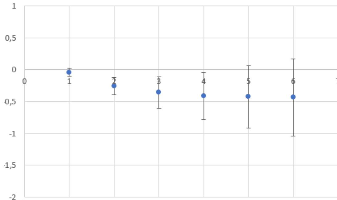
**Slika 27. Odstupanja rezultata gravimet. metode u odnosu na vrijednost etalonskog protokomjera (3.mjerjenje)**
