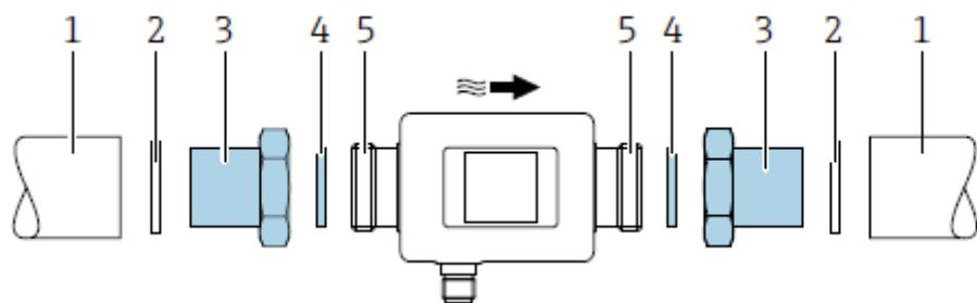
**Slika 20. Sastavni dijelovi potrebni za montiranje na cjevovod**
