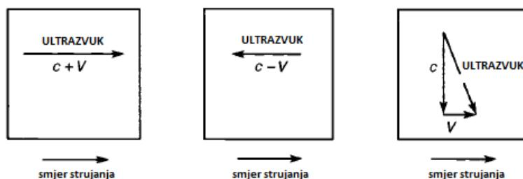
Slika 6. Brzina zvuka u odnosu na smjer strujanja[6]
