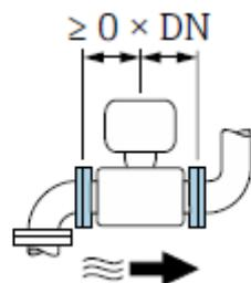
**Slika 19. Prikaz potrebne udaljenosti montiranja u odnosu na koljeno**
