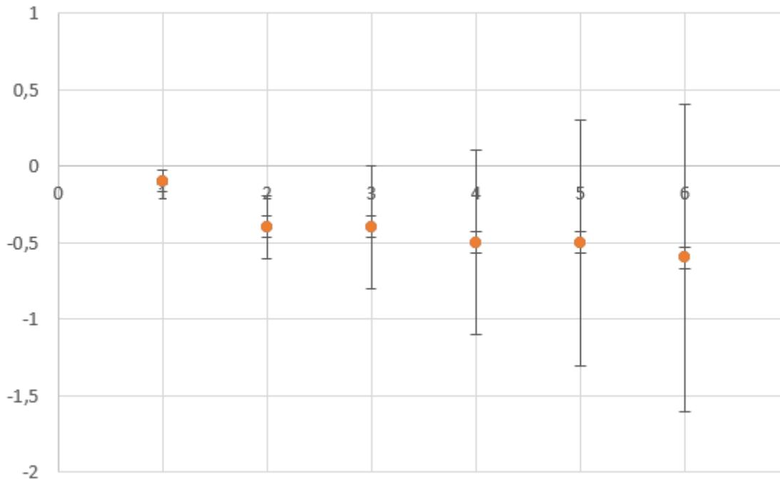
**Slika 22. Odstupanje rezultata PICOMAG-a u odnosu na vrijednost etalonskog protokomjera (1.mjerenje)**
