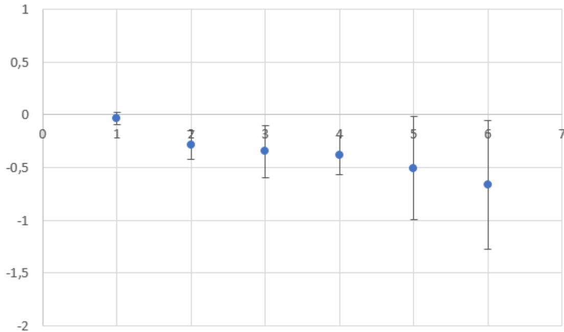
Slika 25. Odstupanja rezultata gravimet. metode u odnosu na vrijednost etalonskog protokomjera (2.mjerjenje)
