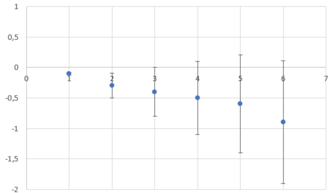
**Slika 24. Odstupanje rezultata PICOMAG-a u odnosu na vrijednost etalonskog protokomjera (2.mjerjenje)**
