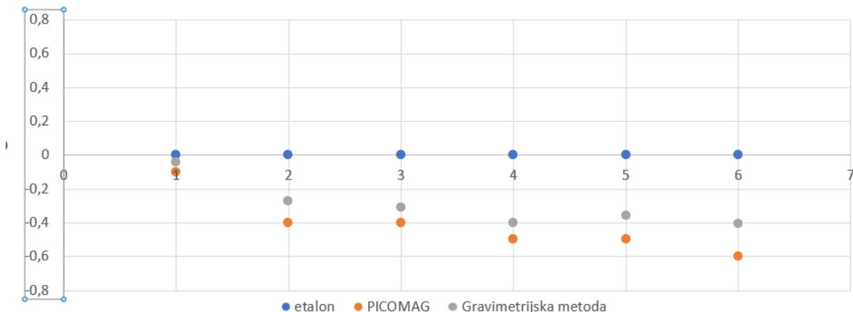
**Slika 28. Usporedba izmjereneh vrijednosti PICOMAG-a i gravimetrijske metode sa zadanim vrijednostima etalonskog protokomjera sa pripadajućim mjernim nesigurnostima**
