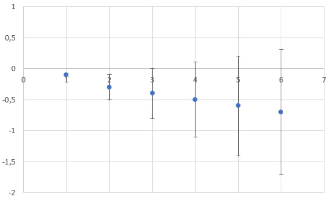
Slika 26. Odstupanje rezultata PICOMAG-a u odnosu na vrijednost etalonskog protokomjera (3.mjerjenje)
