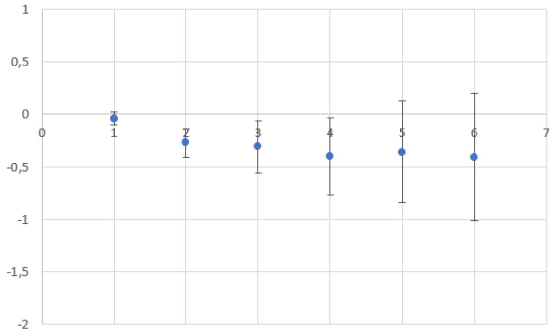
**Slika 23. Odstupanja rezultata gravimet. metode u odnosu na vrijednost etalonskog protokomjera (1.mjerjenje)**
