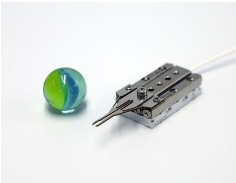
Slika 4: Mikrohvatač SmarAct SG-1730 [2.12]
