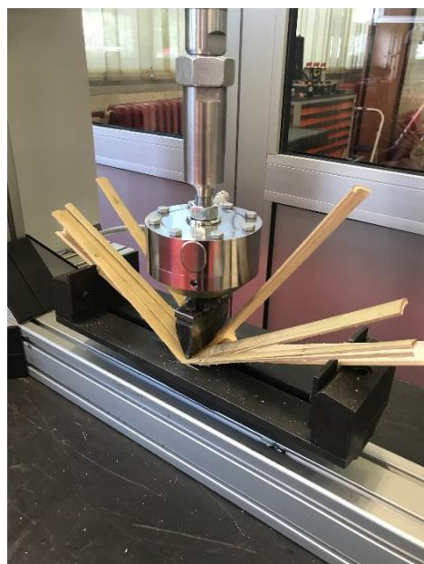
**Slika 11. Uzorak nakon ispitivanja savojne čvrstoće**
