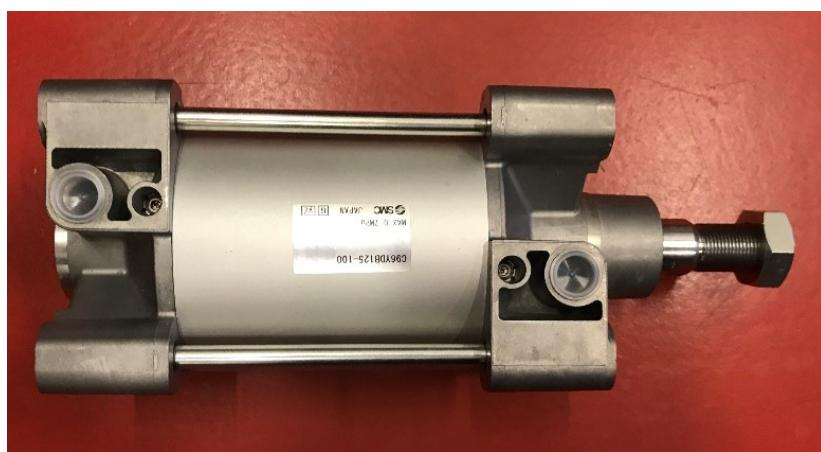
Slika 6. Pneumatski cilindar CY-96YDB125-100 [6]
