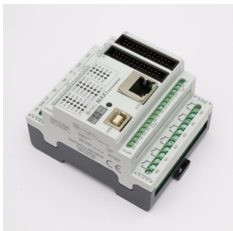
Slika 8. Upravljački uređaj Controllino Maxi Power Automation [8]
