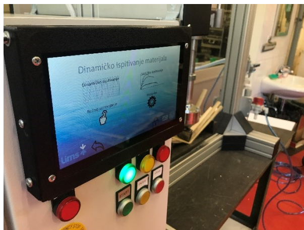
Slika 9. HMI sučelje eksperimentalnog postava
