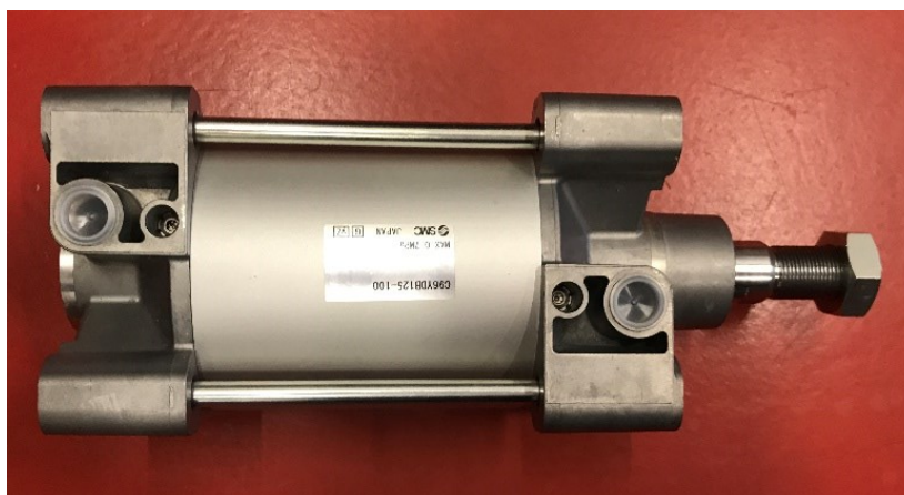
Slika 6. Pneumatski cilindar CY-96YDB125-100 [6]
