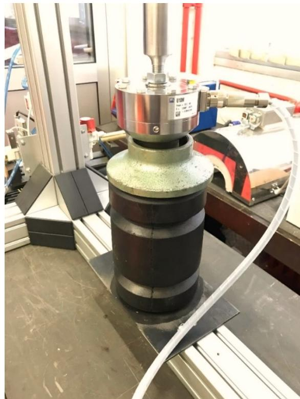
**Slika 43. Eksperimentalni pristup estimiranju parametara s gumenim odstojnikom**
