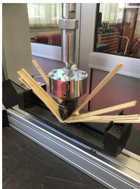
Slika 11. Uzorak nakon ispitivanja savojne čvrstoće
