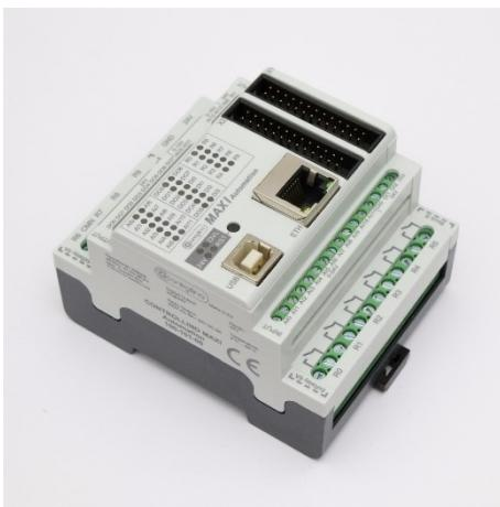
**Slika 8. Upravljački uređaj Controllino Maxi Power Automation [8]**
