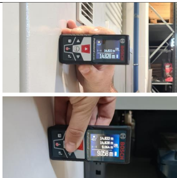
Slika 44. Lasersko mjerenje novog puta do centralnog skladišta
