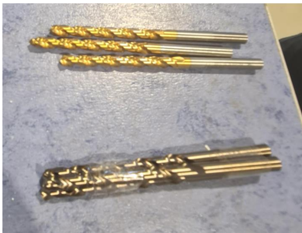
Slika 37. Svrkla s kobaltnim premazom (gore) i stara svrdla bez premaza (dolje)
