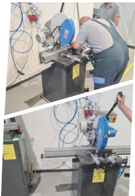
Slika 19. Mjerenje i rezanje sirovca
