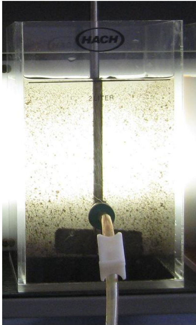
Slika 20. B-posuda (100 \mu L FeCl 3 /2L) za vrijeme flokulacije
