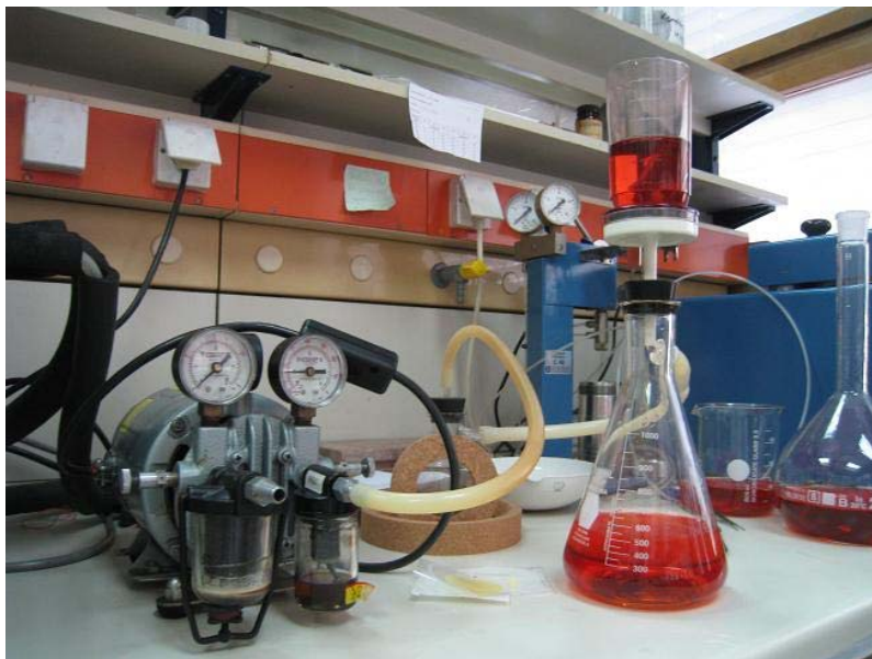
Slika 23. Erlenmeyerova tikvica s posudom za vakuumiranje i vakuum pumpom
