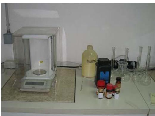
Slika 17. Laboratorijska vaga Mettler toledo AG204
