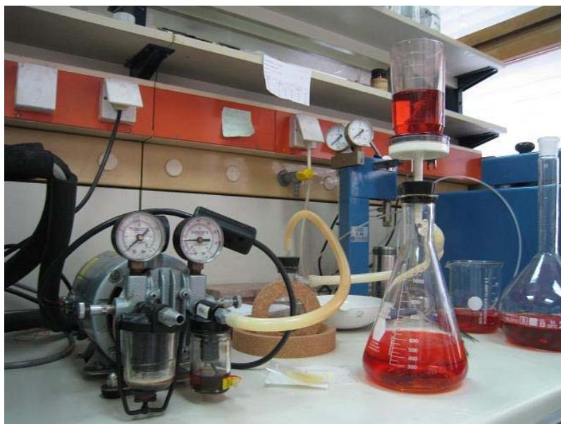
Slika 23. Erlenmeyerova tirkvica s posudom za vakuumiranje i vakuum pumpom
