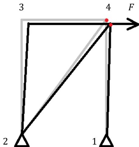
**Slika 10. Deformirana konstrukcija**
