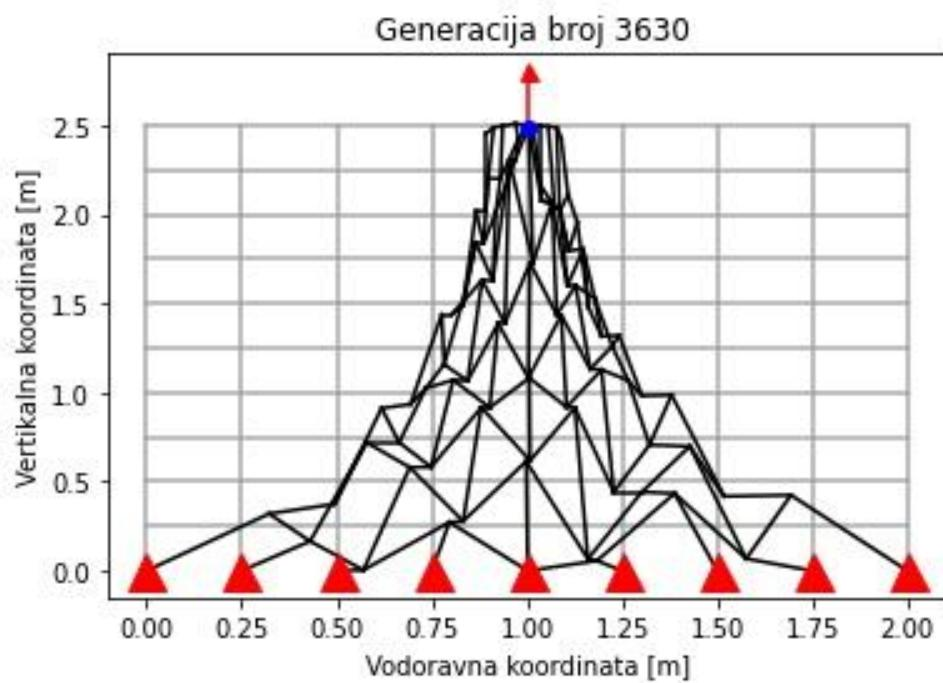
**Slika 30.** Treći pokus evolucije vlačno opterećene konstrukcije
