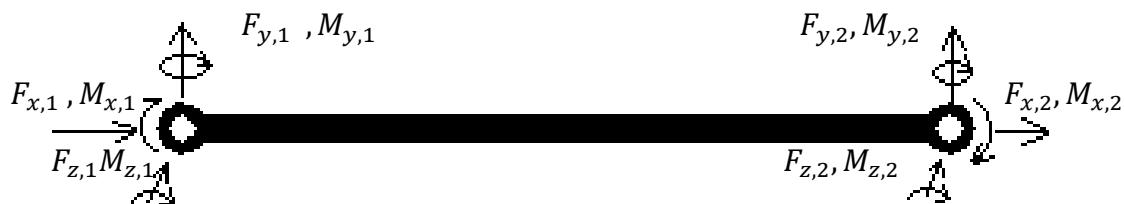
**Slika 7. Gredni element s 12 stupnjeva slobode**
