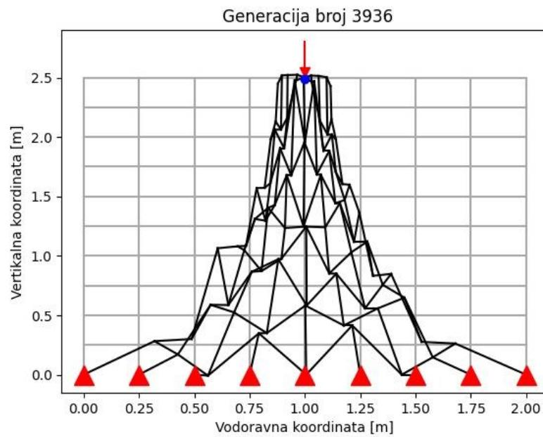
**Slika 23.** Treći pokus evolucije tlačno opterećene konstrukcije
