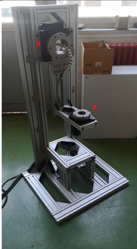
Slika 7. Postolje s prikazom rotacijskih osi ispitnog postava
