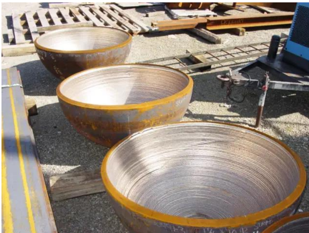
Slika 10 Oblaganje konstrukcijskog čelika nehrđajućim čelikom [24]
