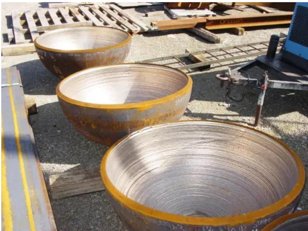
Slika 10 Oblaganje konstrukcijskog čelika nehrđajućim čelikom [24]
