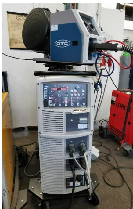
**Slika 20 OTC Welbee W400 dual-inverterski izvor struje**
