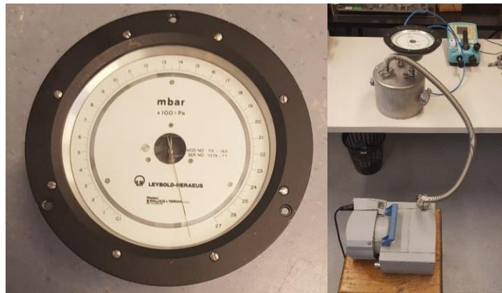
*Slika 27.* Analogni Leybold vakuummetar
