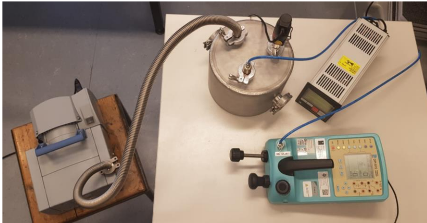
Slika 30. Spoj membranske pumpe na vakuum komoru
