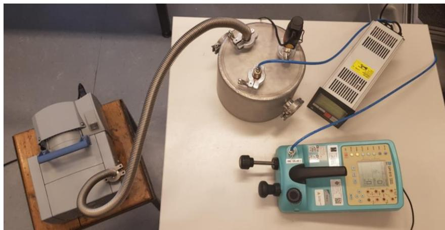
Slika 30. Spoj membranske pumpe na vakuum komoru
