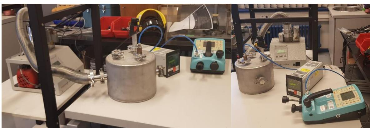
Slika 31. Spoj turbomolekularne pumpe na vakuum komoru
