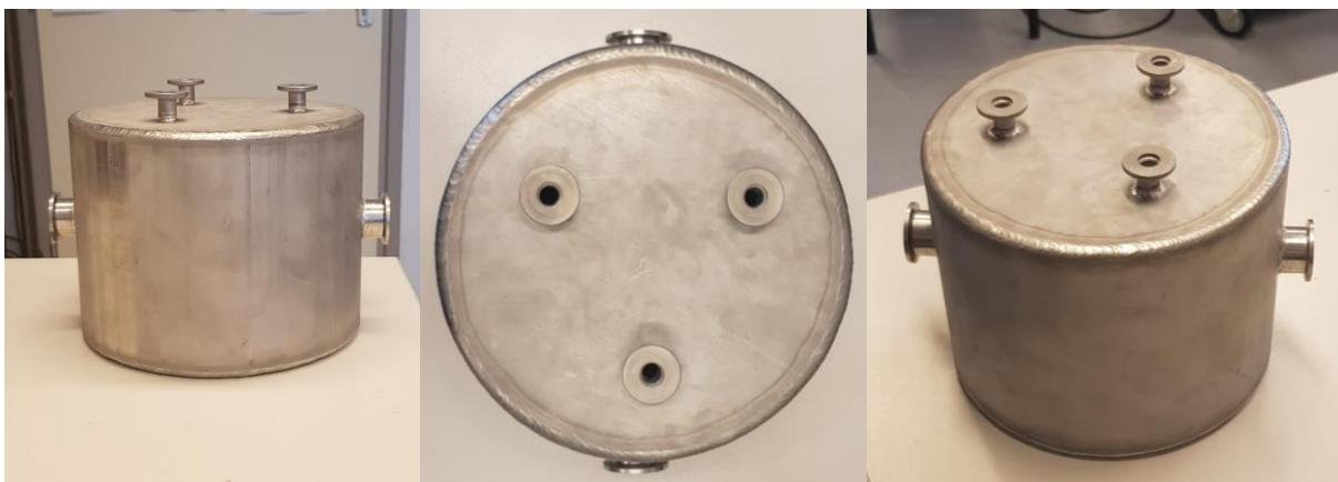
*Slika 25.* Vakuum komora
