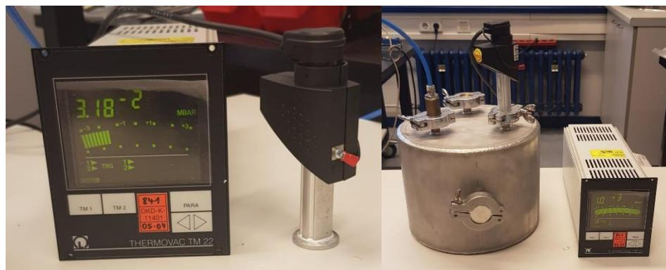
*Slika 29.* Piranijev vakuummetar
