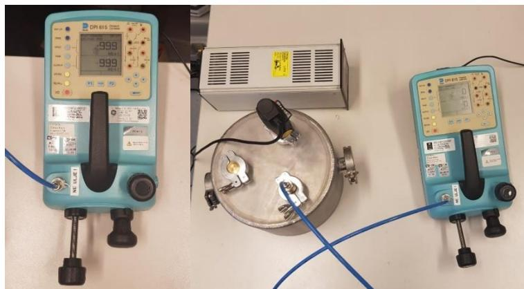
*Slika 28.* Digitalni vakuummetar
