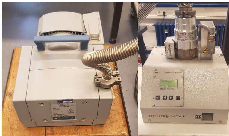
Slika 26. lijevo) Vacubrand-ova membranska vakuum pumpa; desno) Pfeiffer-ova turbomolekularna vakuum pumpa
