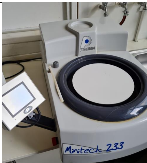
Slika 54. Stroj za brušenje makro uzoraka
