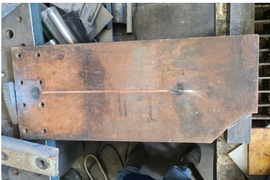
Slika 29. Bakrena podloga korištena kod DC i AC zavarivanja uzoraka
