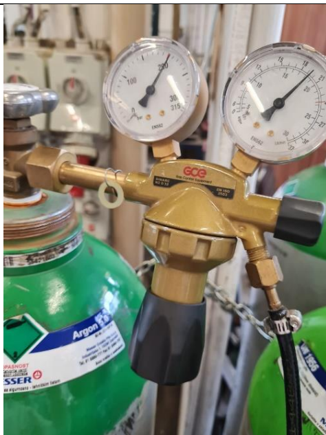
Slika 26. Manometar s protokom zaštitnog plina
