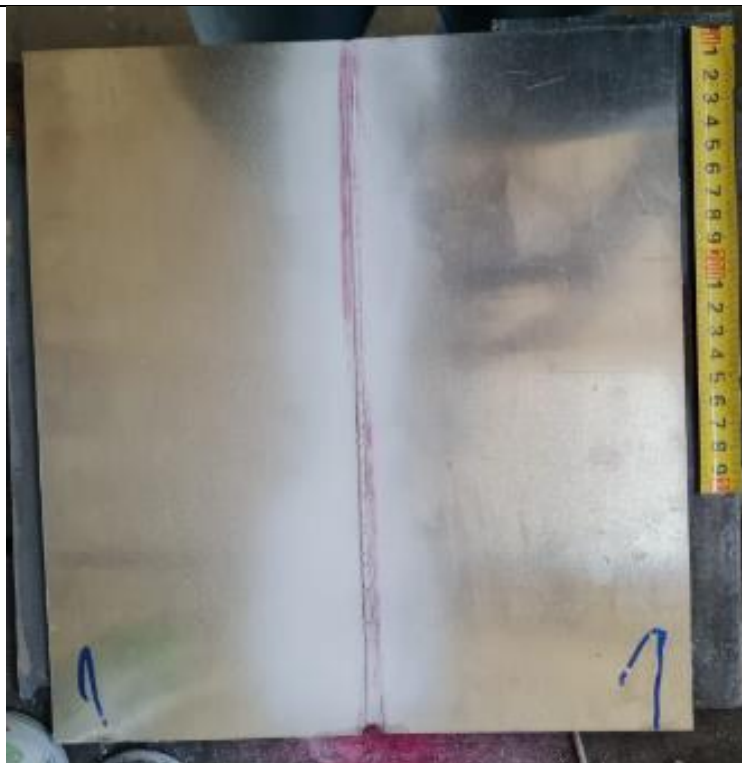
Slika 39. Rezultati ispitivanja penetrantima na korijenu DC zavora
