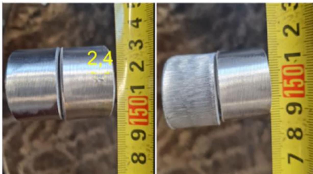
Slika 52. Korijeni i lica DC zavora ispitanih savijanjem
