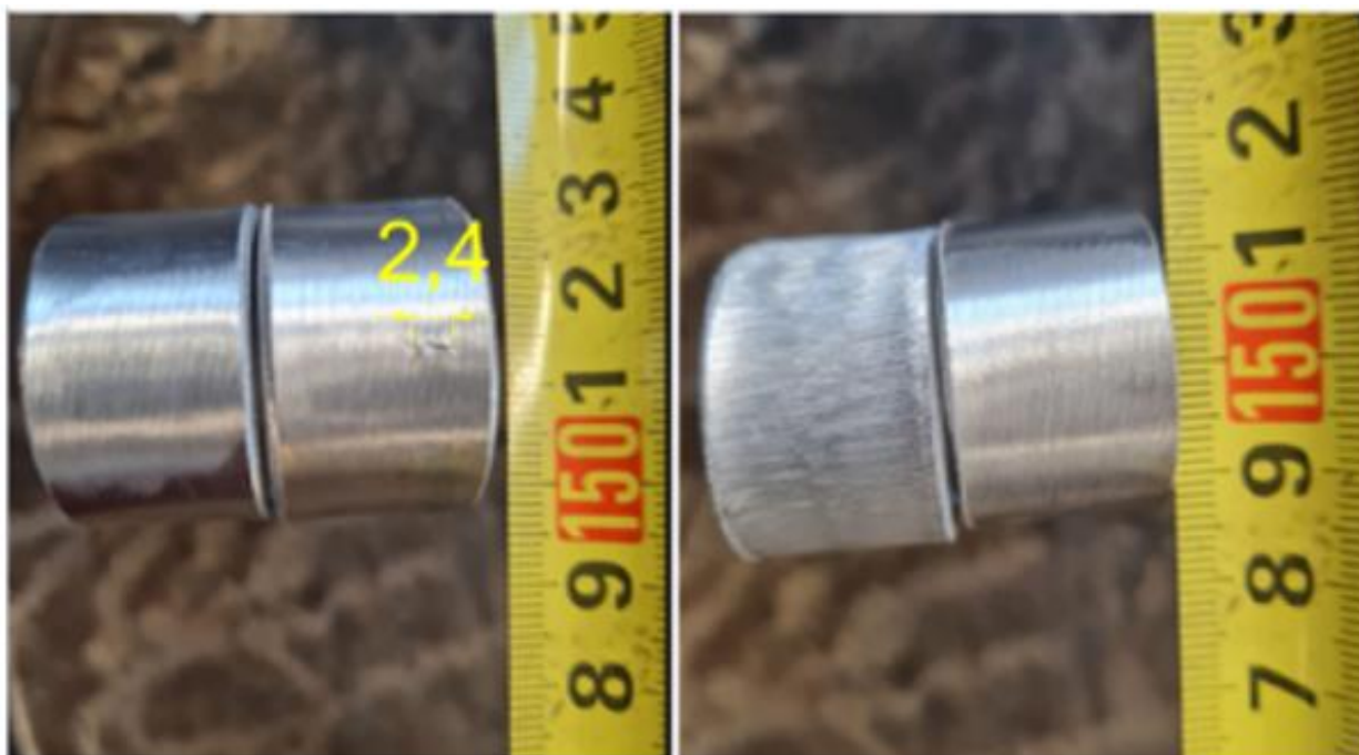
Slika 52. Korijeni i lica DC zavora ispitanih savijanjem
