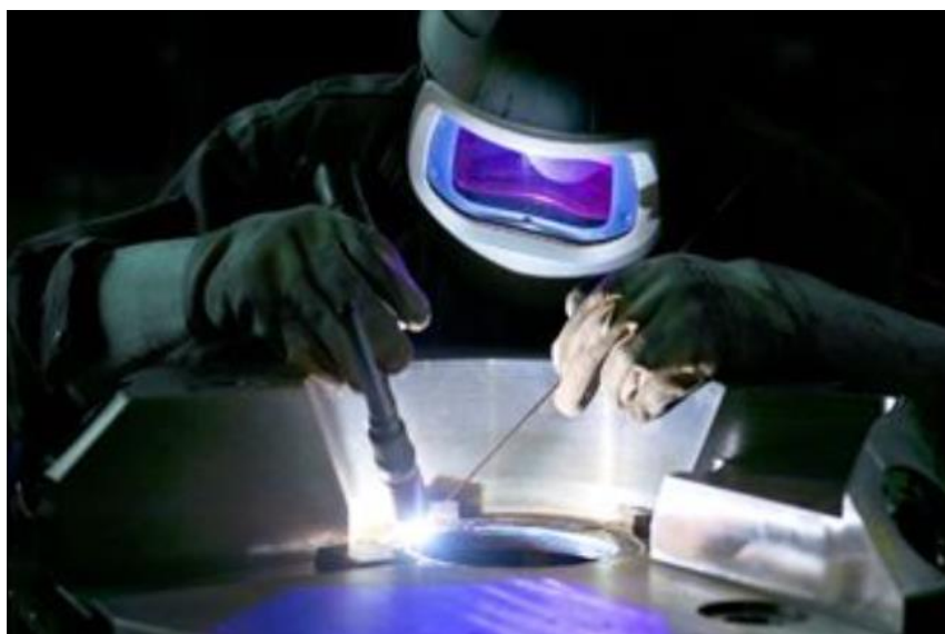
Slika 12. TIG zavarivanje aluminija dodavanjem taljive žice [16]
