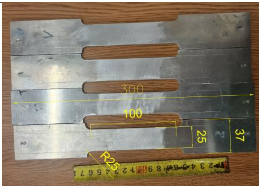
Slika 40. Epruvete uzete od DC i AC uzoraka spremne za statičko vlačno ispitivanje
