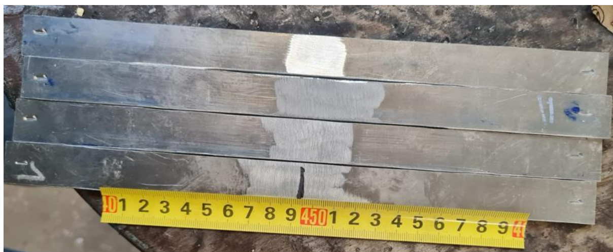
Slika 49. Epruvete uzete od DC uzoraka spremne za ispitivanje savijanjem
