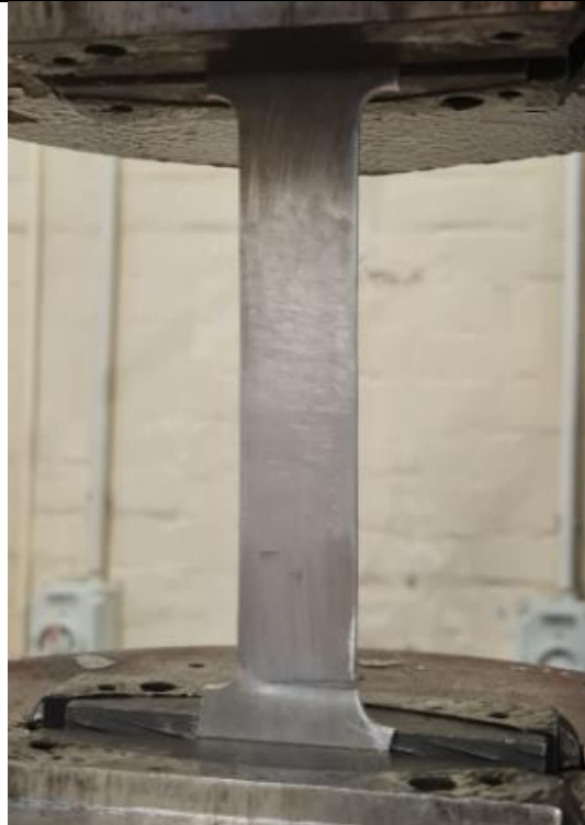
Slika 43. Prikaz uzorka 1b DC zavarenog spoja na kidalici
