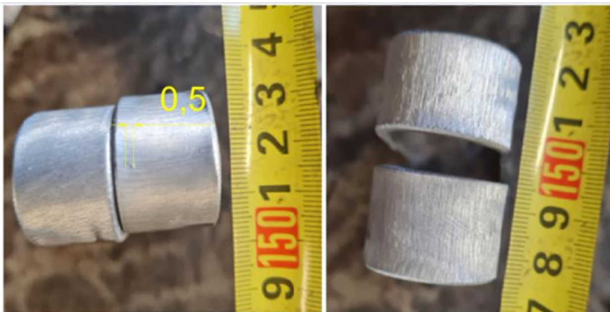
Slika 53. Korijeni i lica AC zavara ispitanih savijanjem
