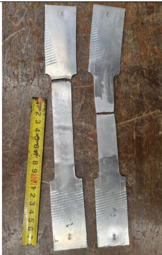
Slika 46. Uzorci 2a i 2b AC zavarenog spoja nakon ispitivanja na kidalici
