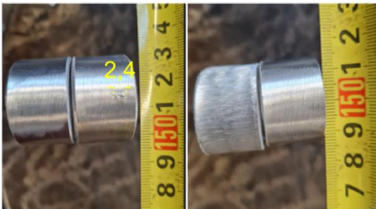
Slika 52. Korijeni i lica DC zavora ispitanih savijanjem
