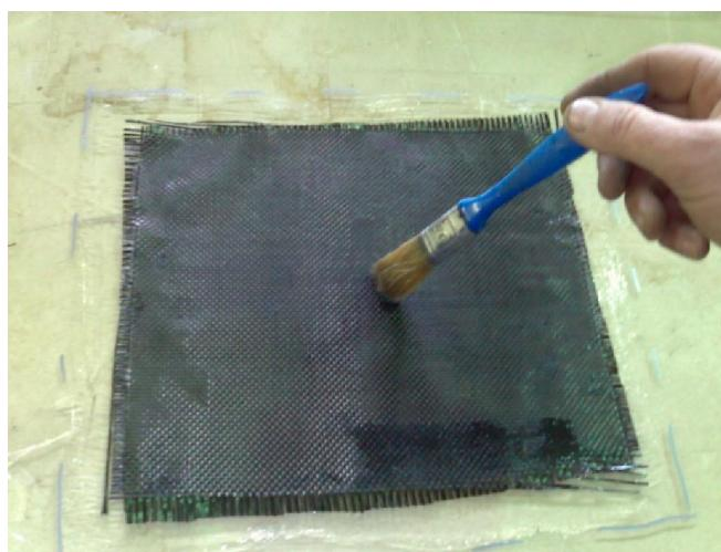
Slika 27 Početak impregniranja prvoga sloja ugljičnih vlakana
