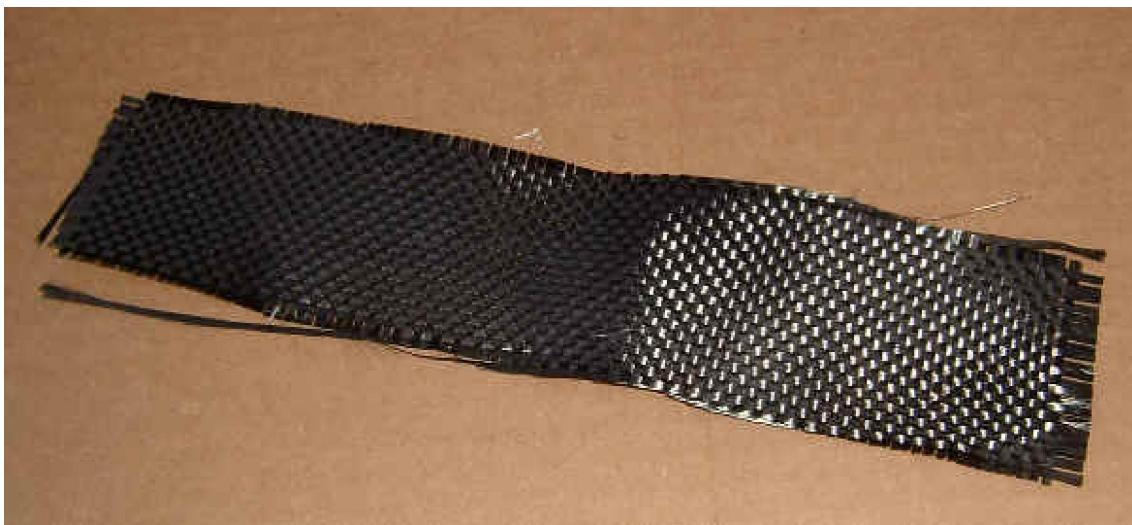
Slika 10. Ugljična vlakna [2]
