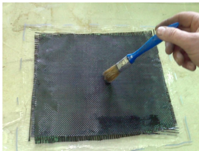
Slika 27 Početak impregniranja prvoga sloja ugljičnih vlakana
