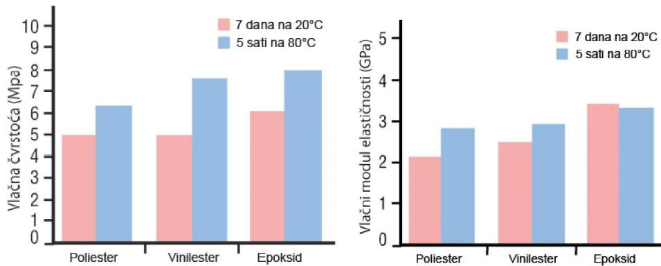
Slika 4 Usporedba vlačne čvrstoće [1], Slika 5 Usporedba vlačnog modula [1]
