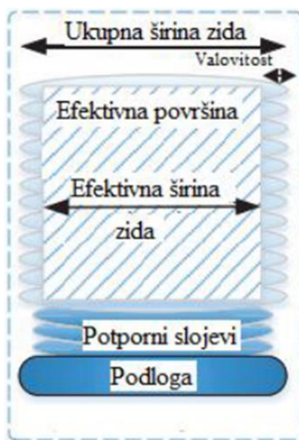
Slika 2. Shematski prikaz zida izrađen WAAM postupkom [5]
