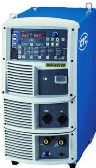
Slika 18. Izvor struje za zavarivanje Welbee W400 [20]
