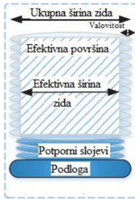
**Slika 2. Shematski prikaz zida izrađen WAAM postupkom [5]**
