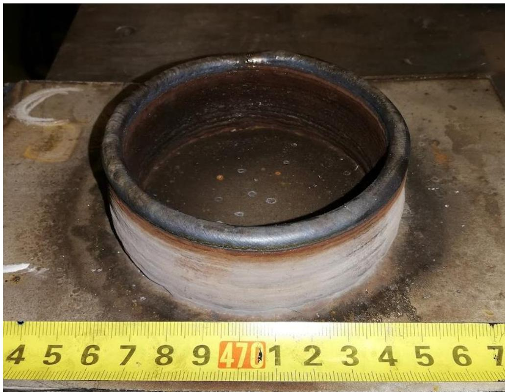
**Slika 26. Uzorak C nakon zavarivanja**
