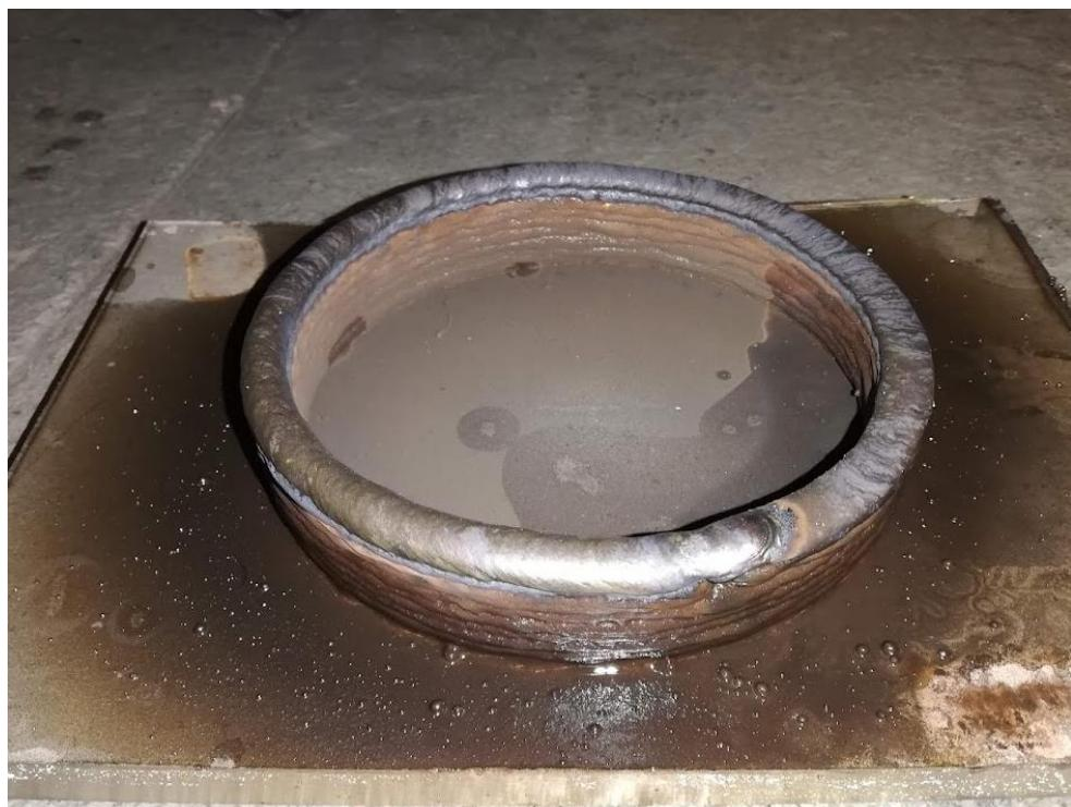
**Slika 24. Uzorak A nakon zavarivanja**
