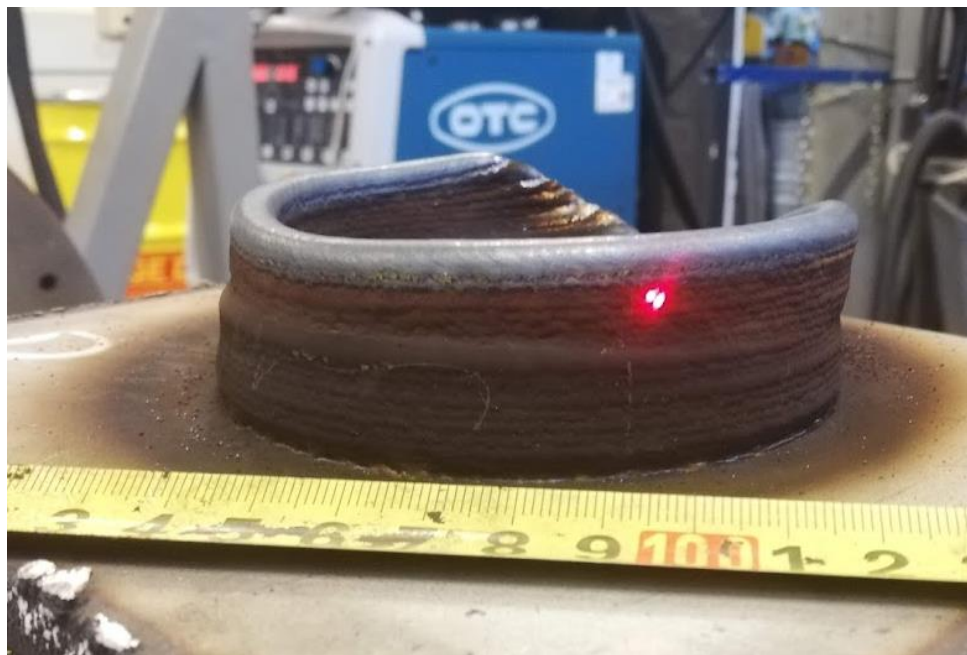
Slika 27. Uzorak D nakon zavarivanja
