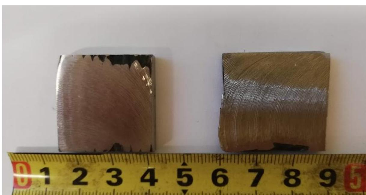
Slika 31. Uzorak B nakon glodenja
