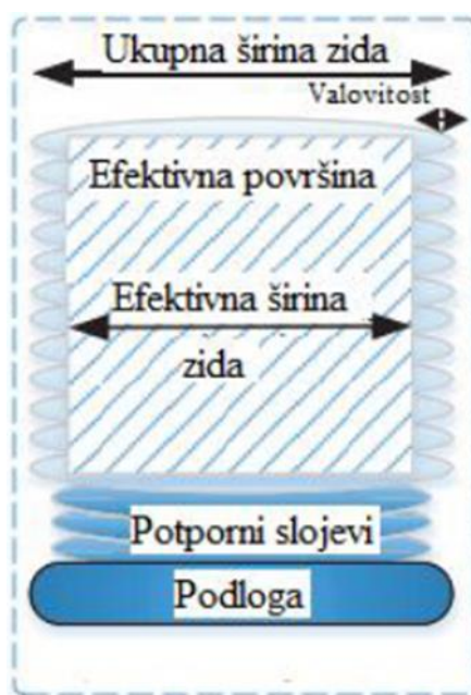
Slika 2. Shematski prikaz zida izrađen WAAM postupkom [5]
