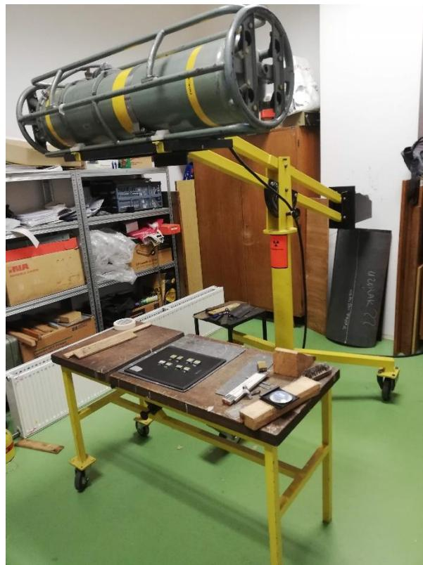
**Slika 50.** Oprema za radiografsko ispitivanje
