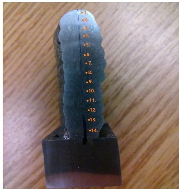
Slika 48. Točke mjerenja tvrdoće na uzorku A
