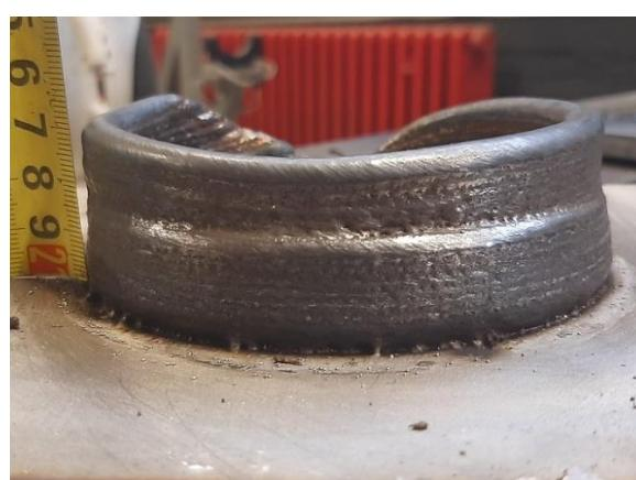
Slika 28. Uzorci nakon čišćenja i odmašćivanja
