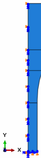
Slika 28 Model epruvete s pripadnim rubnim uvjetima.
