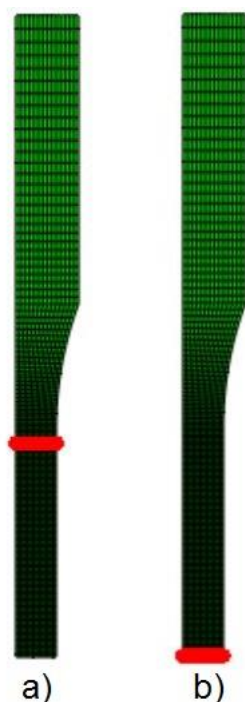
Slika 33 a) Mjerna zona definirana prema poziciji ekstenzometra na monotonom vlačnom testu, b) Set čvorova za koje su ispisane sile reakcije
