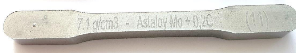
Slika 24 Epruveta materijala Astaloy Mo+0,2C gustoće 7,1 \text{ g/cm}^3
